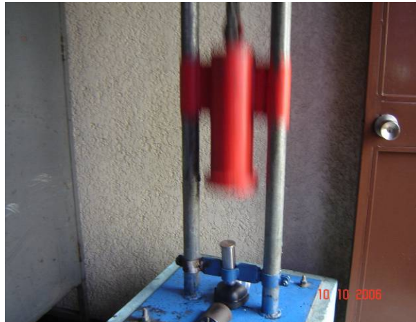
Figura 12: Elaboración de prueba de impacto a punteras de calzado de seguridad
