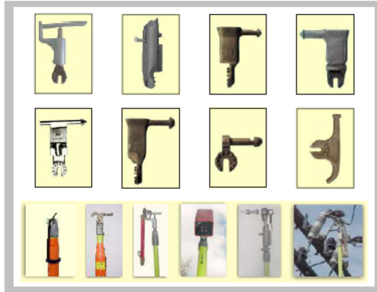
Figura 19: Cabezales de maniobra y aplicaciones de pértigas.
