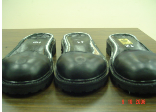
Figura 11: Calzado de seguridad con la prueba de compresión elaborada
