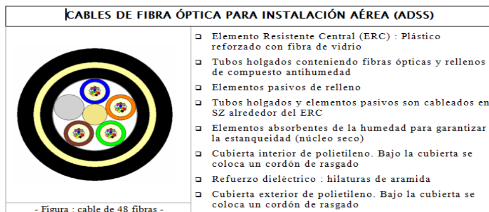
Figura 18 Fibra óptica tipo ADSS de 48 Hilos
