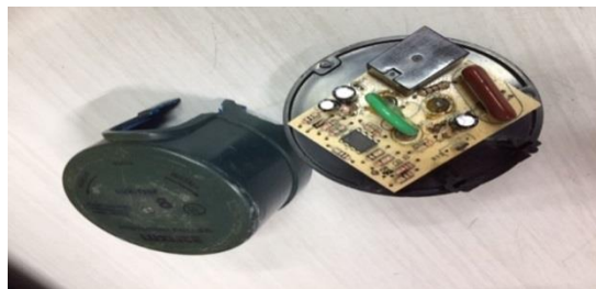
Figura 4. Componentes internos de fotocontrol de lámpara de alumbrado público
