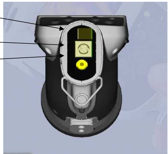
Figura 14. Puertos de Comunicación de la Cámara Termográfica E65
