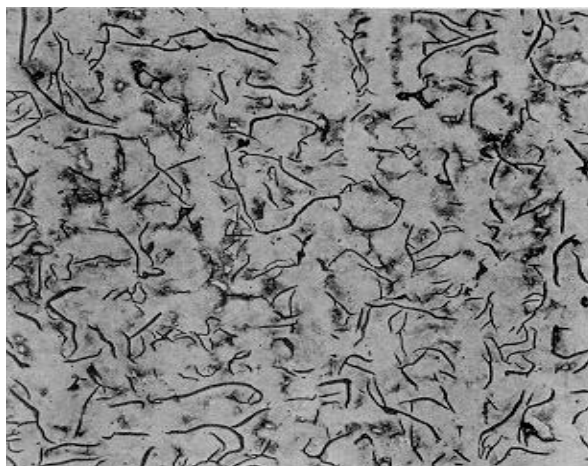
Figura 4. Grafito en fundición gris 80X
