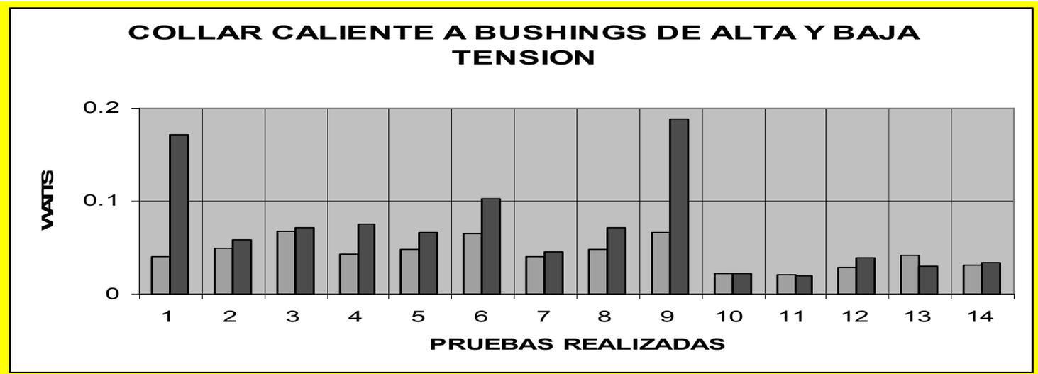
Según la gráfica presentada a lo que se refiere a la prueba de collar caliente para los bushings de alta y baja tensión, cabe destacar que en la campana dos de H1, el valor se encuentra excedido; así también a lo que se refiere a la campana dieciséis de H2, y en la campana dieciséis de H3, los valores se encuentran excedidos de su valor tomado como máximo en las normas vigentes referentes a esta prueba, no así estas aun se encuentran entre los niveles de tolerancia aceptables.
