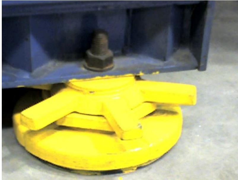
Figura 46. Soporte amortiguador manual (Inyectora)
