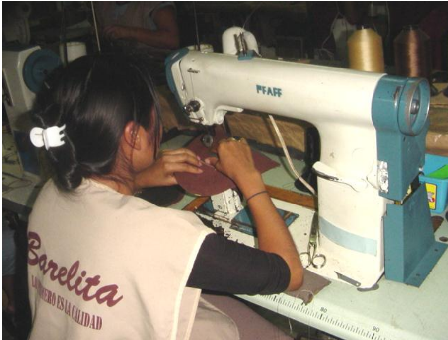
Figura 6. Fotografía operaciones de pespunte
