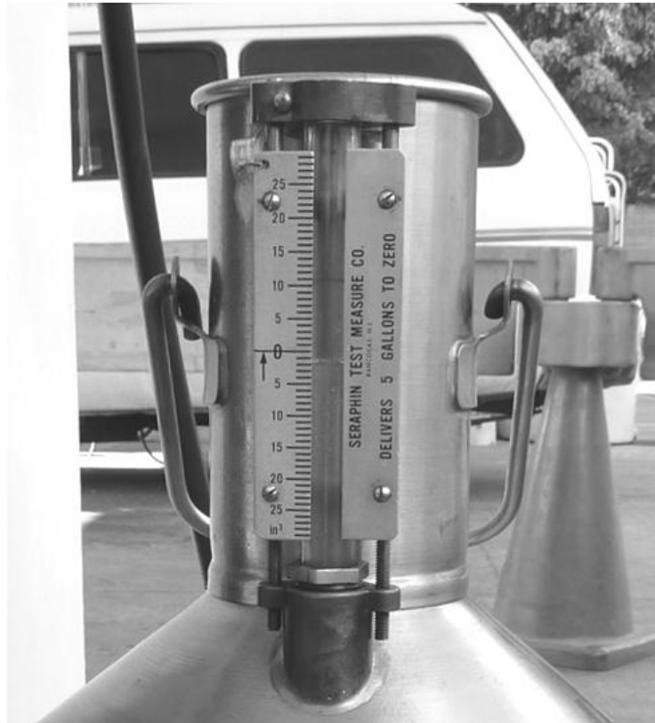
Figura 17. Lectura del volumen dentro del Seraphin después de la segunda corrida en el ejemplo 3
