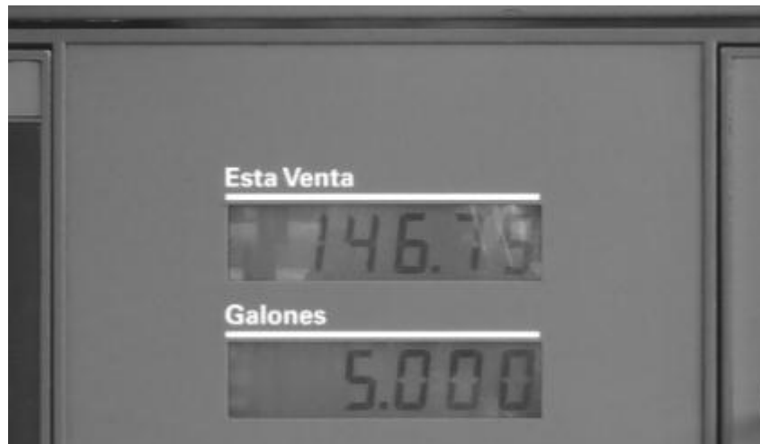
Figura 16. Lectura del panel electrónico de la bomba dispensadora mostrando el volumen despachado
