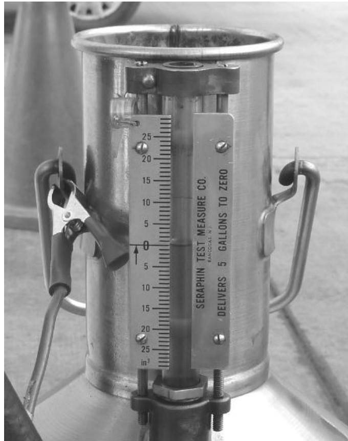
Figura 12. Medición del volumen dentro del Seraphin después de calibración en el ejemplo 1
