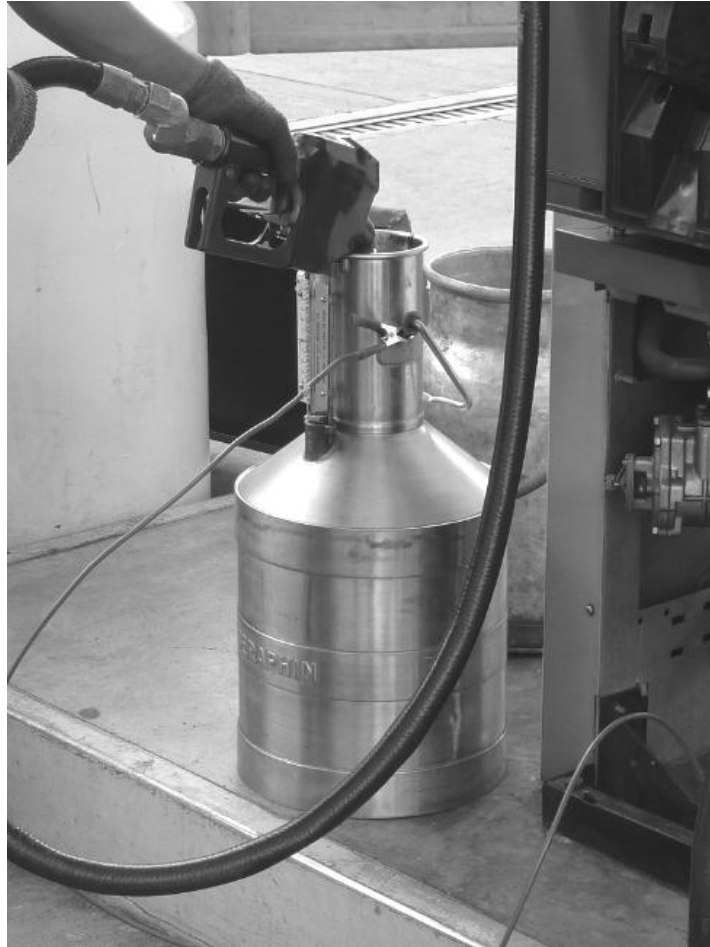
Figura 15. Método correcto de utilización del Seraphin
