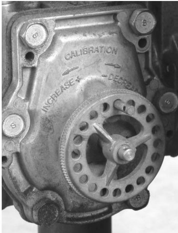
Figura 9. Sistema de calibración de ajustes del medidor
