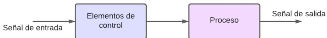
*Nota.* Diagrama que muestra la función de un sistema de control de lazo abierto. Elaboración propia, realizado con Lucidchart.
