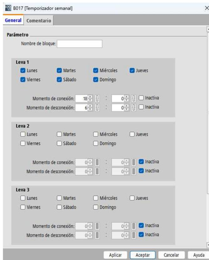
*Nota.* Configuración del bloque B017, temporizador semanal para el módulo 4: Invernadero hidropónico industrial. Elaboración propia, realizado con LOGO! Soft Comfort V8.3.
