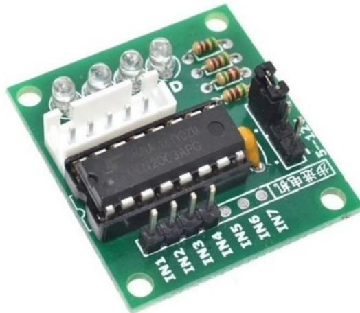
*Nota.* En la figura se puede observar la forma que tiene el módulo controlador con el integrado ULN2003 que es muy popular en la mayoría de las tiendas de electrónica por su facilidad de uso y bajo costo. Obtenido de La Electrónica. *MÓDULO CONTROLADOR DE STEPPER ULN2003.* (<https://laelectronica.com.gt/modulo-uln2003-controlador-de-motor-stepper>), consultado el 24 de julio de 2023. De dominio público.
