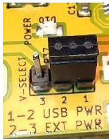
*Nota.* El Pin selector de la tarjeta Elbert V2 configurado para funcionar por medio de alimentación USB. Elaboración propia.
