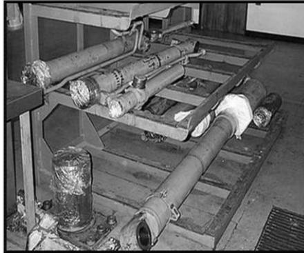
Los cañones de los cilindros se almacenan en estanterías especialmente diseñadas y los extremos de los cilindros se cubren o protegen después de la limpieza.
