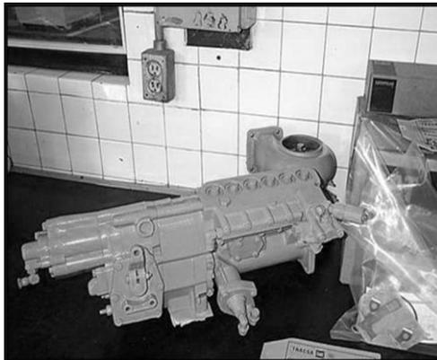
Los orificios de admisión, salida y cubierta de la bomba de inyección están tapados con tapas y tapones correctos.
