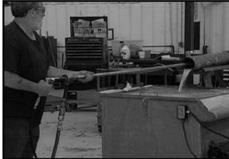
Los cilindros se lavan con escobilla y solución de limpieza. Proceso implementado para comprobar la limpieza del cañón del cilindro.
