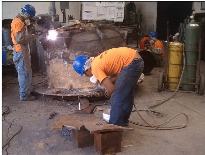
Figura 2. Mantenimiento en un crisol
