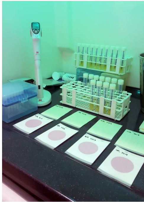
Figura 9. Identificación de muestras en los distintos medios de cultivo que se utilizan para análisis de alimentos y agua. Laboratorio de control de calidad de alimentos. IRTRA de Retalhuleu
