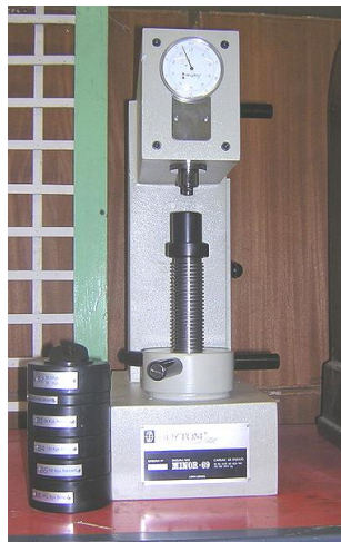
Figura 16. Durómetro para el ensayo de dureza con Rockwell
