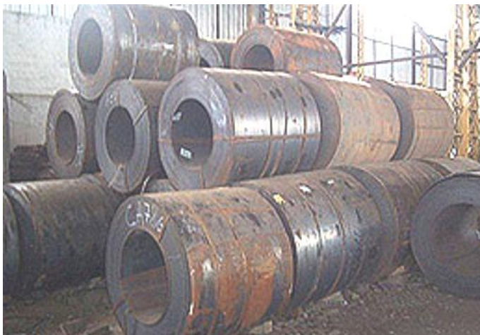
Figura 20. Deterioro de la lámina en el ambiente
