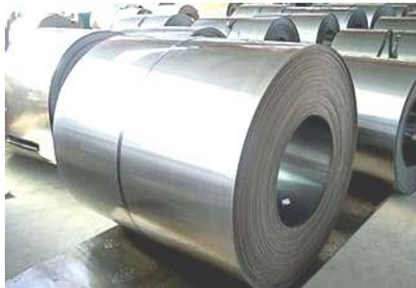
Figura 6. Planchas metálicas para envasado
