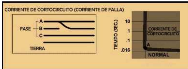
Figura 3. Curva de tiempo-corriente de cortocircuito
