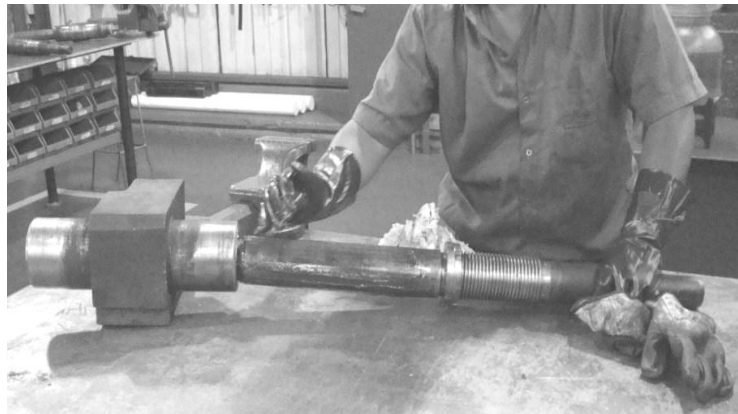
Figura 38. Lubricación del eje de regulación
