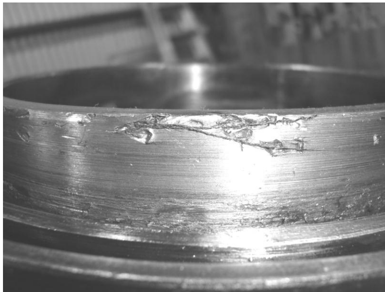
Figura 42. Laberinto con desprendimiento de material
