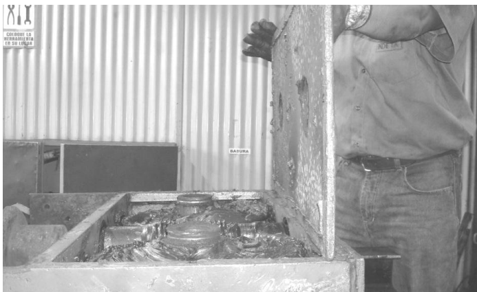
Figura 21. Desmontaje de tapadera de gabbia
