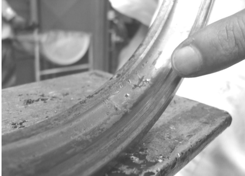
Figura 49. Rodamiento de carga axial con aro exterior dañado
