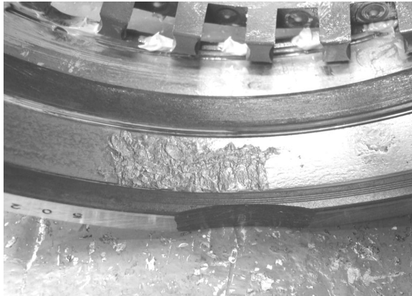
Figura 48. Rodamiento R con aro exterior dañado
