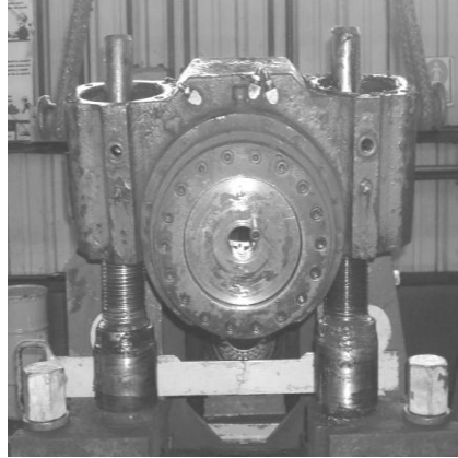
Figura 15. Desmontaje de chumacera superior
