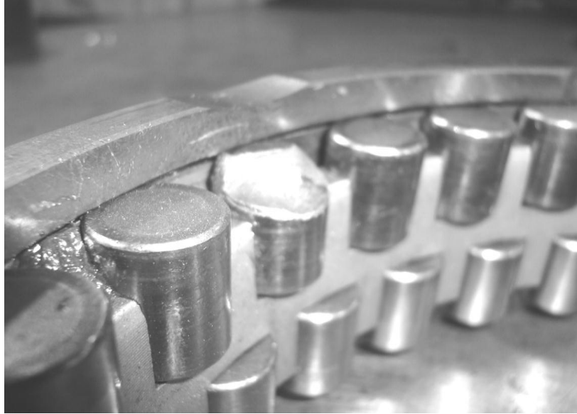
Figura 47. Rodamiento R con rodillo fracturado
