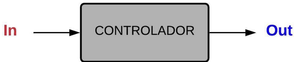
Figura 4. Sistema de control de lazo abierto
