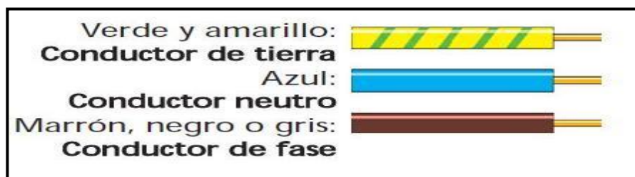
Figura 22. Color de aislamiento de cables
