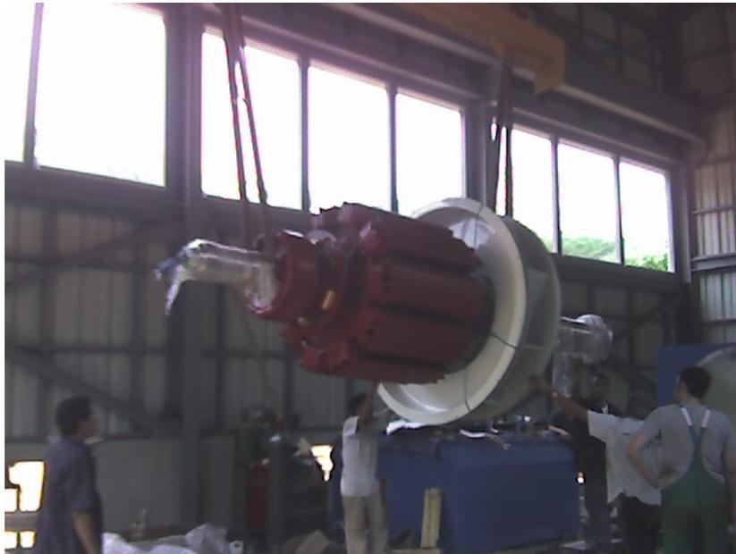
Finalizado este paso, se procedió a colocar la tapadera del generador, así como la caja terminal de conexiones, se verifico la posición de los cojinetes y se llevo a cabo el ajuste de los mismos, verificación de niveles adecuados de lubricación en ellos.
