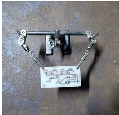
Figura 78. Sujeción de PCB
