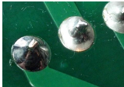
Figura 81. Soldadura circular correcta
