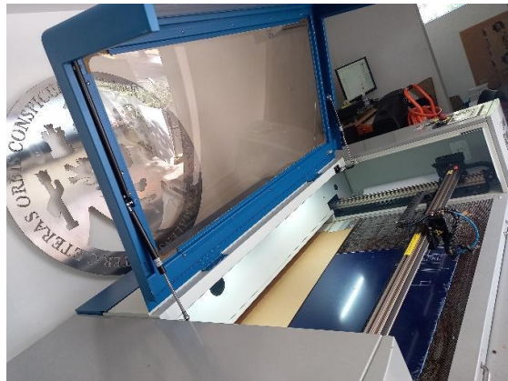
Figura 107. Proceso de corte láser en CNC
