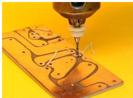
Figura 76. Utilización de taladro para perforar PCBs
