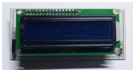
Figura 93. Montaje de Shield para pantalla LCD e interfaz I2C
