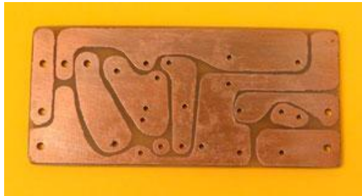
Figura 77. Resultado final del perforado
