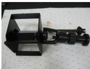
Figura 63. Paso número tres B de armado de cabeza de rectificación
