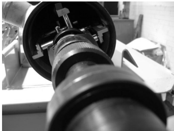
Figura 13. Rectificación del diámetro interior de un cilindro
