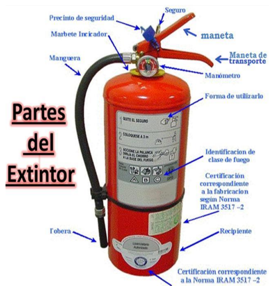
Figura 77. Esquema de un extintor de fuego y sus partes
