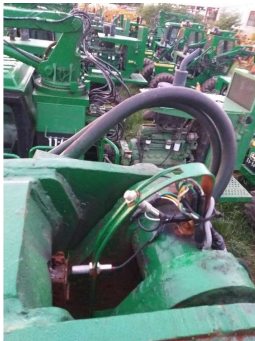
Figura 84. Sensores de efecto Hall en la base de arco de la pluma
