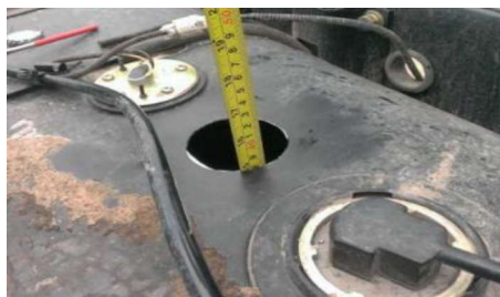
Figura 71. Medición del fondo del tanque
