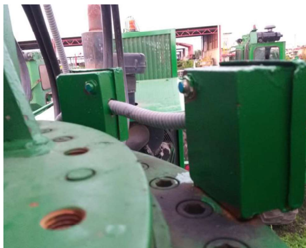
Figura 61. Vista frontal, bases de los sensores de efecto Hall en la tornamesa
