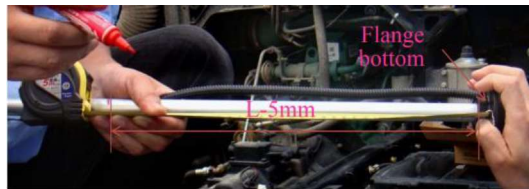
Figura 72. Medición del corte en el señor GLTV7
