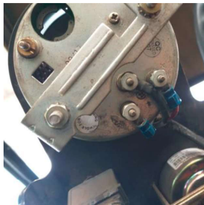
Figura 49. Pines del tacómetro de la máquina alzadora
