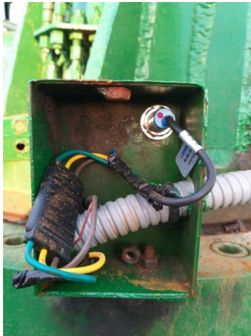
Figura 80. Sensor de efecto Hall en la base de la tornamesa
