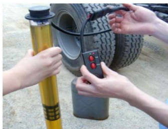
Figura 75. Sensor sumergido en diésel
