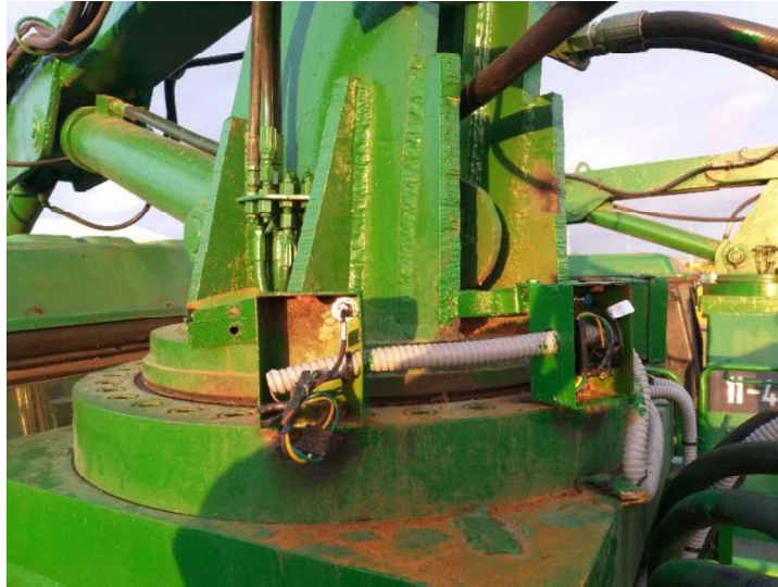
Figura 81. Sensores de efecto Hall en la tornamesa
