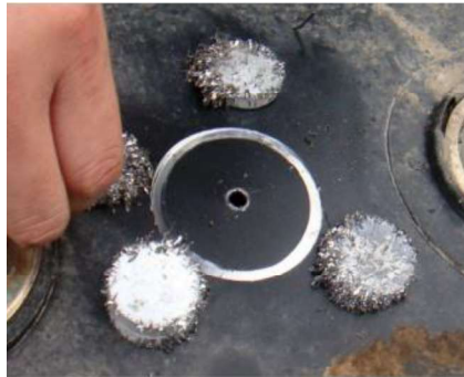
Figura 70. Perforación en el tanque
