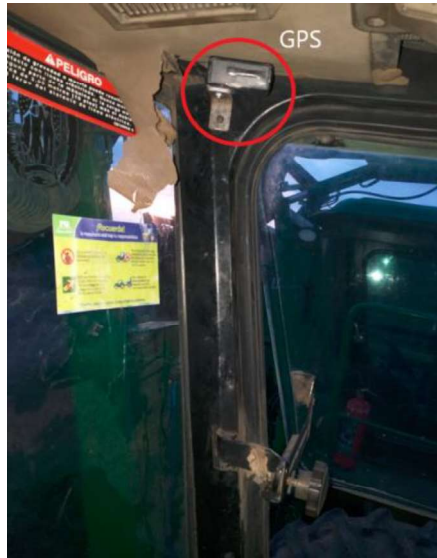
Figura 42. Instalación del módulo GPS
