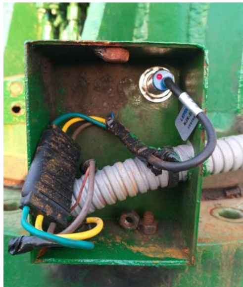
Figura 60. Sensor de efecto Hall en la base de la tornamesa
