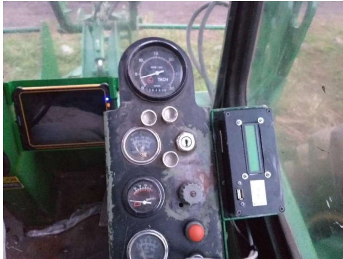
Figura 83. Enclosure y tablet en sus bases dentro de la cabina
