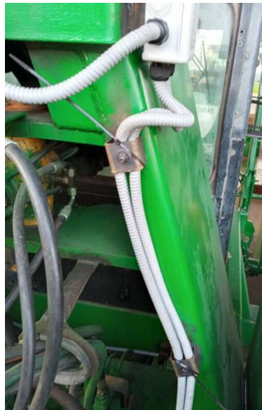
Figura 44. Cableado de los sensores de efecto Hall hacia la cabina
