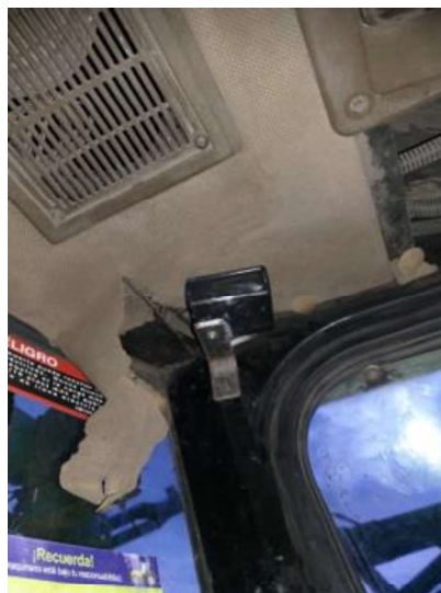
Figura 78. Localización módulo GPS en máquina alzadora 2254
