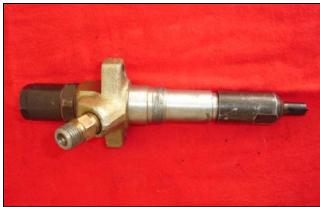
Figura 14. Inyector de 4 orificios marca Boch utilizado por los camiones de la flota de distribución
