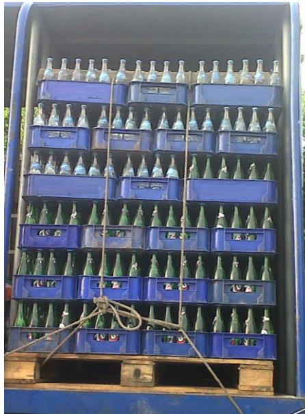
Figura 11. Forma de asegurar la carga que transporta la flota de vehículos utilizando sogas
