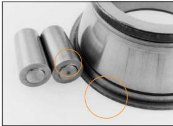
Figura 4. Desgaste por partículas finas en rodamientos
