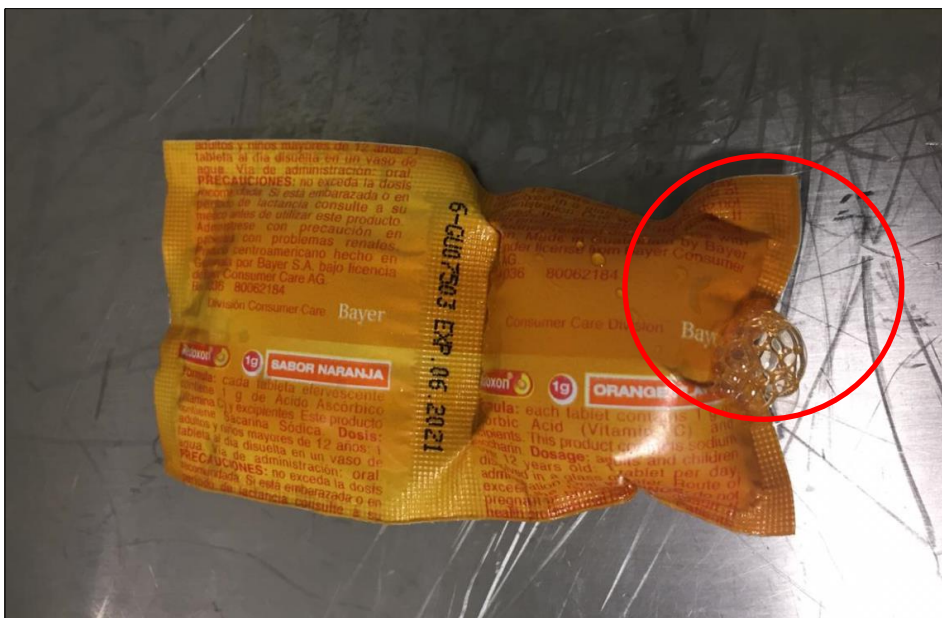
Figura 13. Efecto potencial de falla: pérdida de hermeticidad por corte
