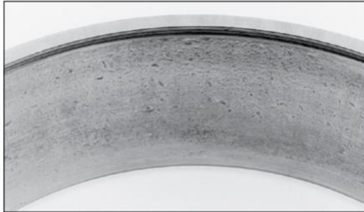
Figura 5. Desgaste por abolladuras por escaso mantenimiento
