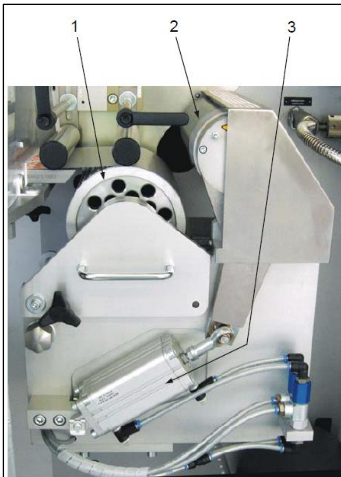
Figura 23. Estación de sellado de blisteadora Noack N921
