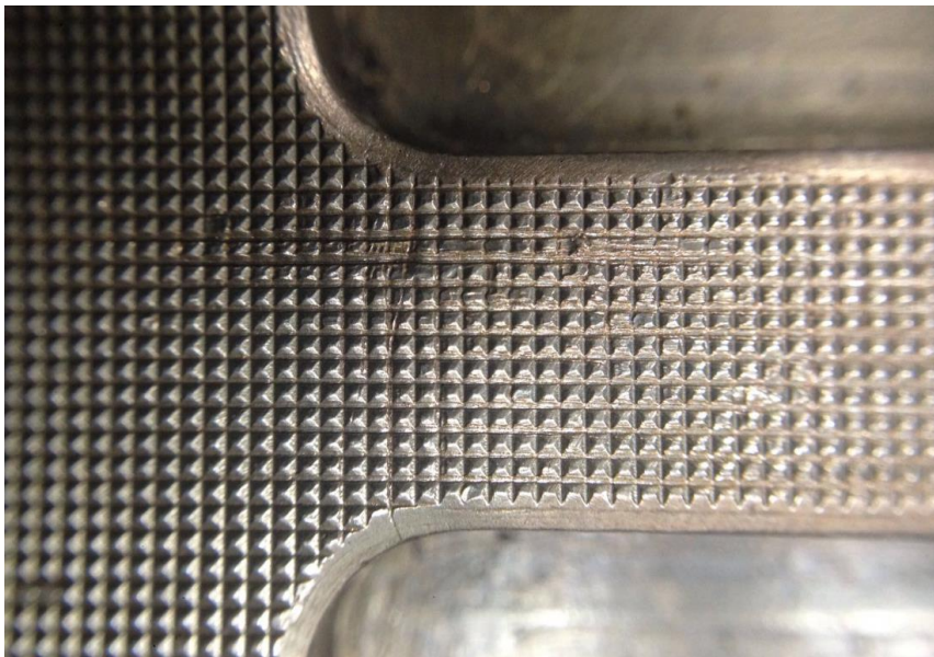
Figura 15. Modo de falla potencial: superficie de sellado
