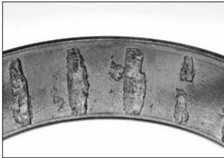
Figura 7. Descascarillado por marcas de agua en la pista
