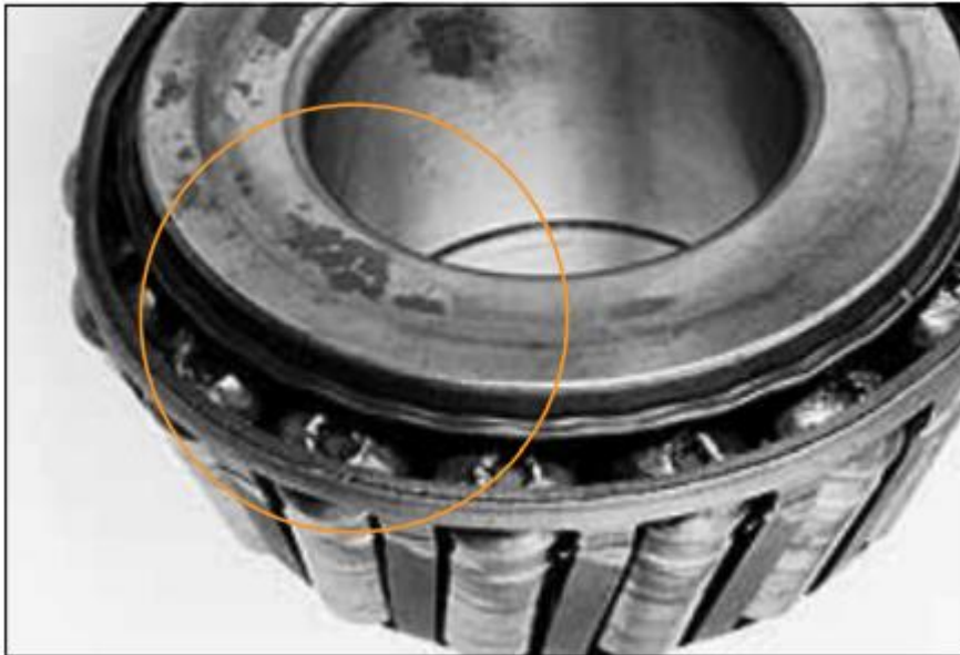
Figura 10. Flujo de metal avanzado por atoramiento de rodamiento
