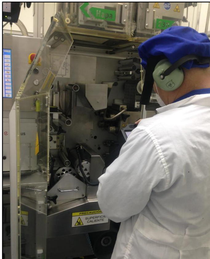
Figura 25. Medición en rodamiento 1 de blisteadora Noack N921
