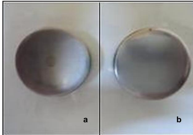
**a) Probeta atacada con nital 5%; b) Probeta pulida hasta lija #2500**
