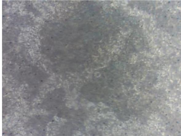
Atacado con Nital 5%. Magnificación 1000x. Muestra una proporción de aproximadamente 50-50 de ferrita y perlita.
