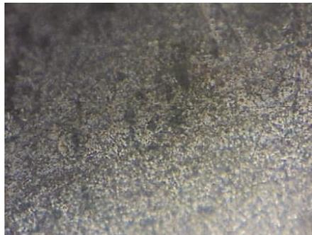
Calentado por 45 minutos a 900°C y enfriado en el horno (recocido). Atacado con Nital 5%. Magnificación 500x. La cantidad de perlita disminuye en la zona de soldadura, según tabla VIII, el contenido de carbono es de 0.05%, se observan algunos carburos de cromo, aunque no se distinguen con facilidad.
