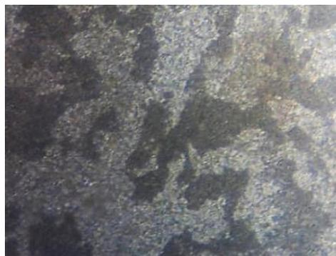
Calentado por 45 minutos a 900°C y enfriado en el horno (recocido). Atacado con Nital 5%. Magnificación 500x. Se observa un crecimiento considerable de los constituyentes, ferrita y perlita.
