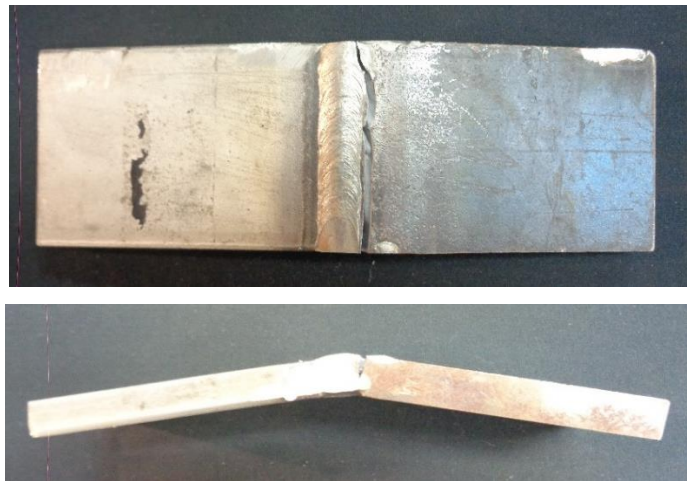
Figura 55. Probeta doblada de aceros disimiles 304 y DF 2
