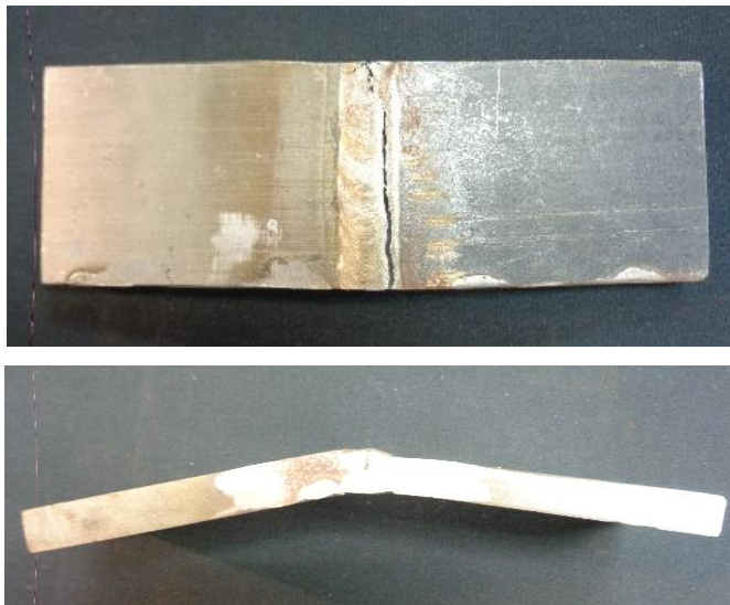
Figura 53. Probeta doblada de aceros disimiles 420 y DF 2
