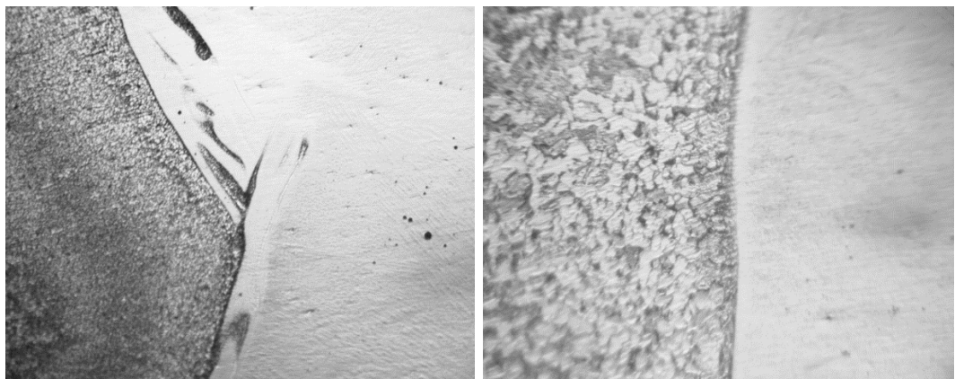
Figura 74. Límite del cordón unión aceros 420-1018, observación 100X y 400X, reactivo dos
