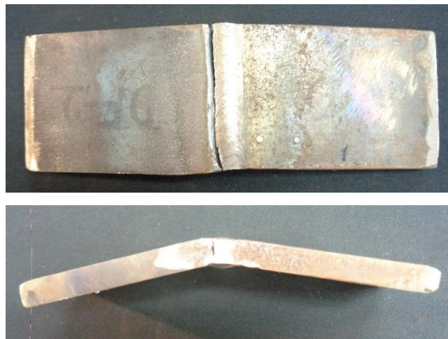
Figura 54. Probeta doblada de aceros disimiles 1018 y DF 2
