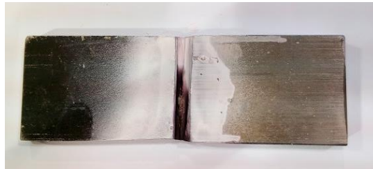
Figura 32. Probeta disímil acero DF2 y 420, unión 100% Ni, con END de líquidos penetrantes
