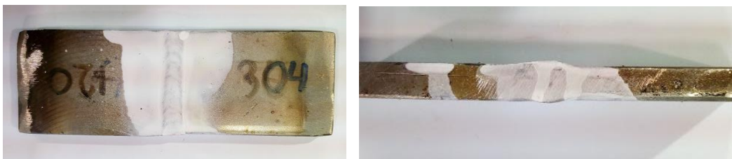
Figura 36. Probeta disímil de acero 304 y 420, unión 309L-16, con END de líquidos penetrantes, uno
