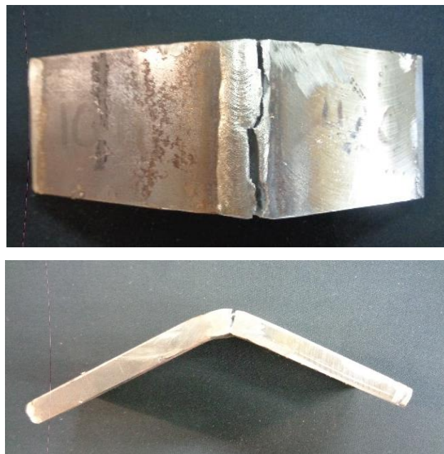
Figura 51. Probeta doblada de aceros disimiles 1018 y 420
