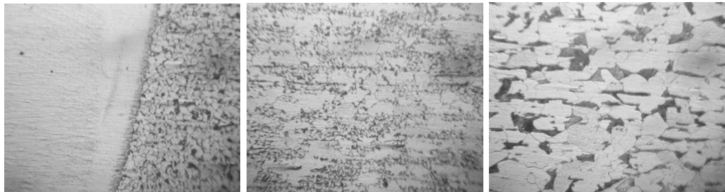
Figura 82. Secuencia de la ZAC en la unión 1018-DF 2, observación 400X, reactivo dos
