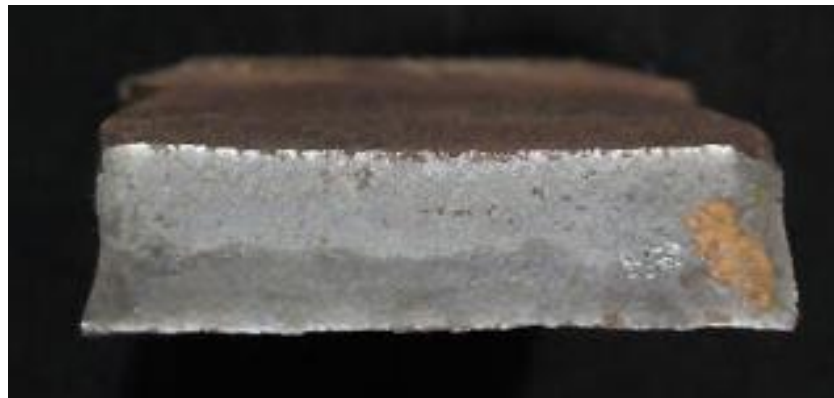
Figura 46. Falla en probeta de aceros disimiles 304-1018
