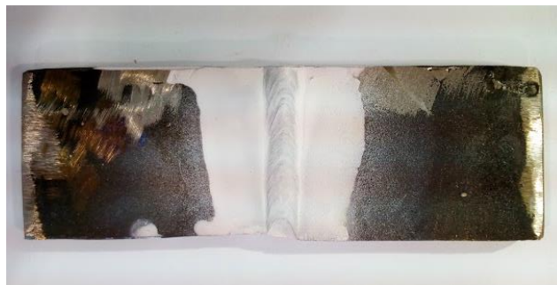
Figura 42. Probeta disímil aceros 1018 y DF 2, unión 309L-16, con END de líquidos penetrantes, uno
