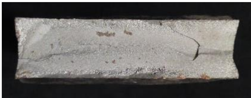
Figura 45. Falla en probeta de aceros disimiles 304-DF 2
