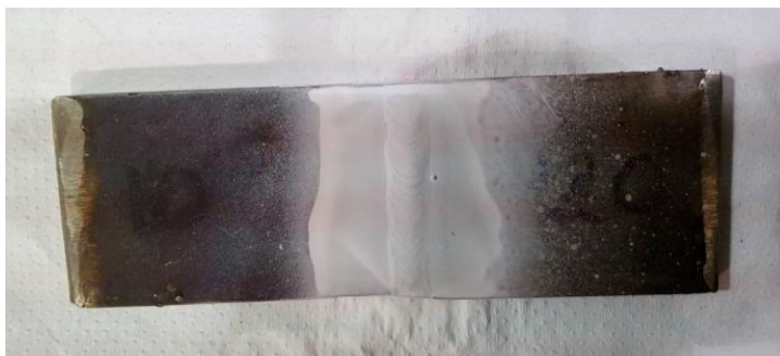
Figura 39. Probeta disímil aceros 420 y 1018, unión 309L-16, con END de líquidos penetrantes, dos
