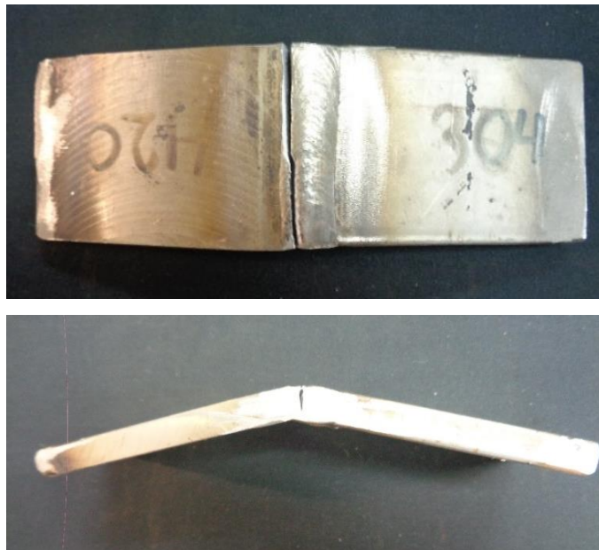
Figura 52. Probeta doblada de aceros disimiles 304 y 420
