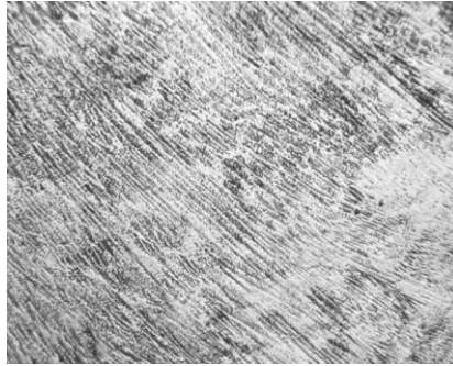
Figura 76. Cordón de unión 420-1018, observación 100X, reactivo uno
