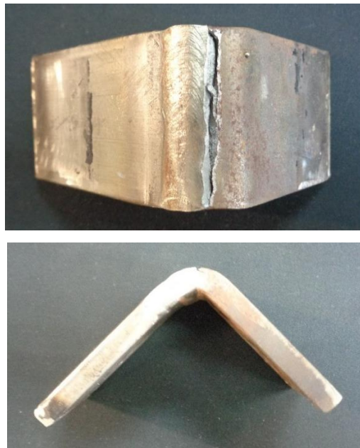
Figura 50. Probeta doblada de aceros disimiles 1018 y 304
