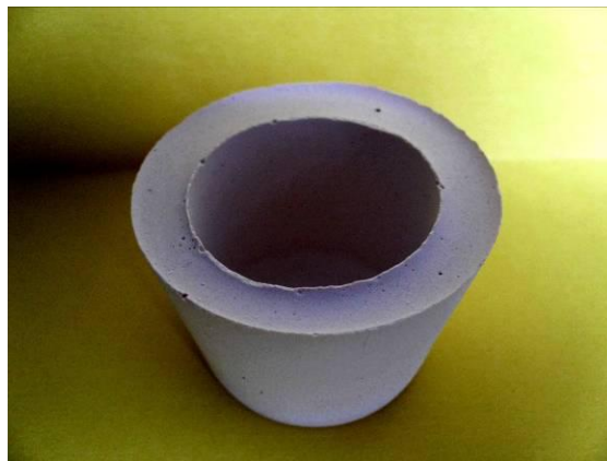
Figura 89. Crisol hecho de revestimiento para la primera fundición
