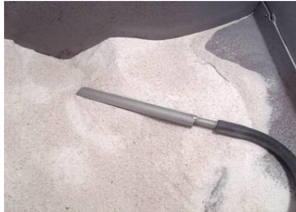
Figura 109. Tubo de alimentación de arena para la boquilla lanzadora del equipo de sandblasting
