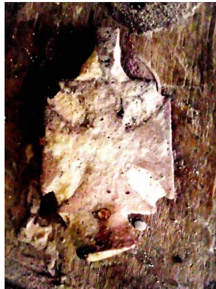
Figura 103. Pieza de plata recién fundida fuera del cilindro
