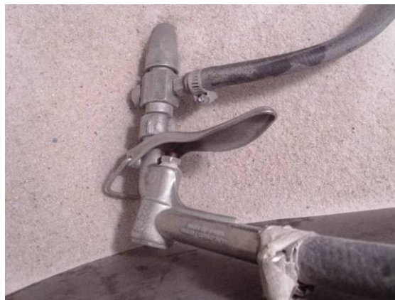
Figura 108. Boquilla lanzadora de arena para sandblasting
