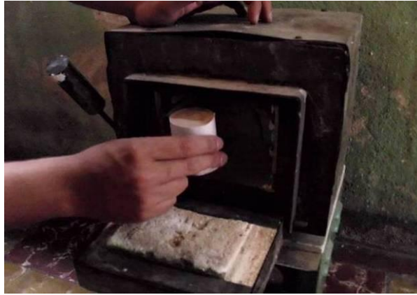
Figura 92. Colocación del molde (cilindro) dentro del horno eléctrico
