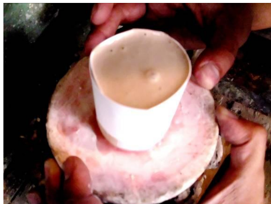
Figura 86. Cilindro de cartón lleno de revestimiento, cubriendo el modelo de cera, colocado sobre un equipo de vibración para eliminar burbujas de aire
