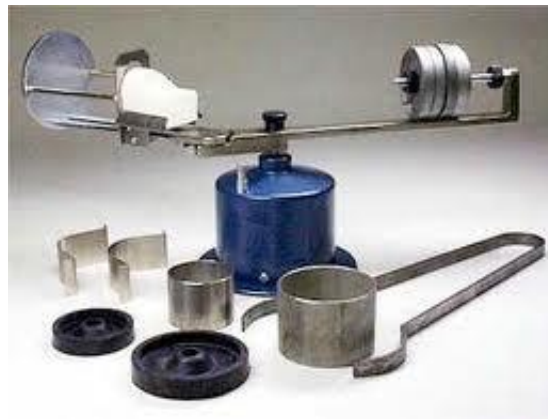
Figura 31. Máquina centrífuga utilizada para la fundición centrifugada en la mecánica dental y en joyería
