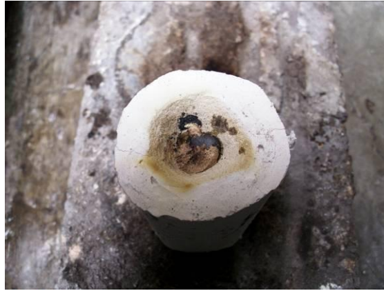
Figura 100. Cilindro enfriado con agua después del colado
