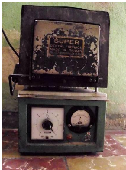
Figura 93. Horno eléctrico utilizado en la fundición
