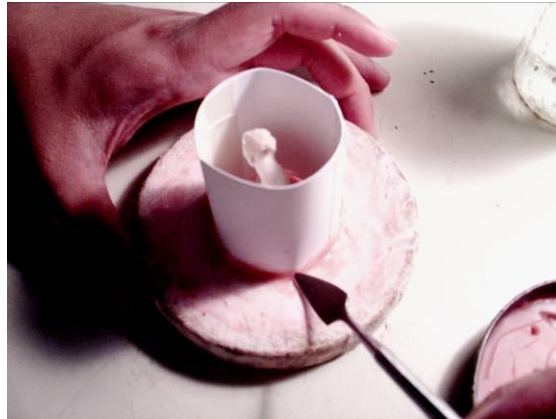
Figura 85. Colocación del cilindro de cartón alrededor del modelo de cera, adhiriéndolo con cera en su base
