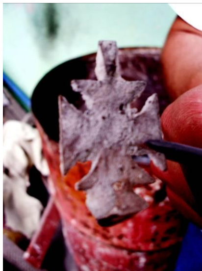
Figura 104. Pieza fundida después de retirar el exceso de revestimiento de su superficie
