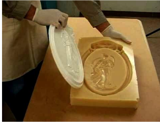
Figura 36. Molde de caucho de uretano
