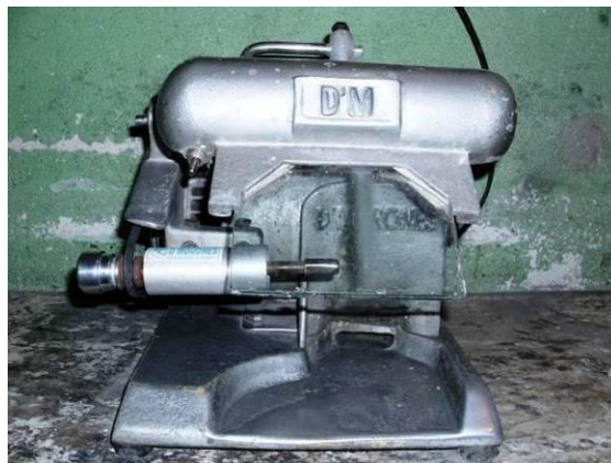
Figura 111. Motor eléctrico utilizado para el pulimento y pulido de la pieza
