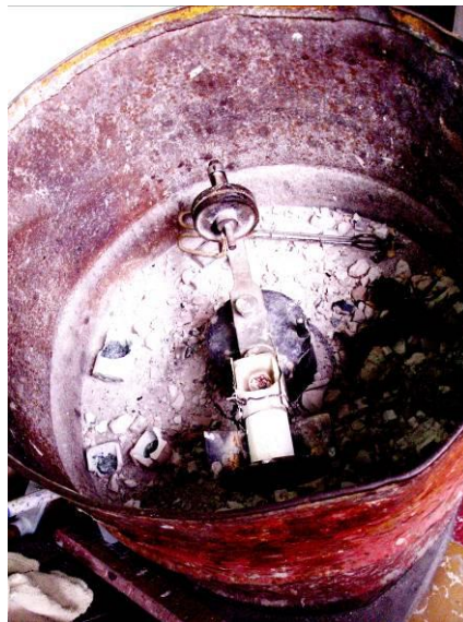
Figura 98. Centrífuga detenida después de la fundición, final del colado
