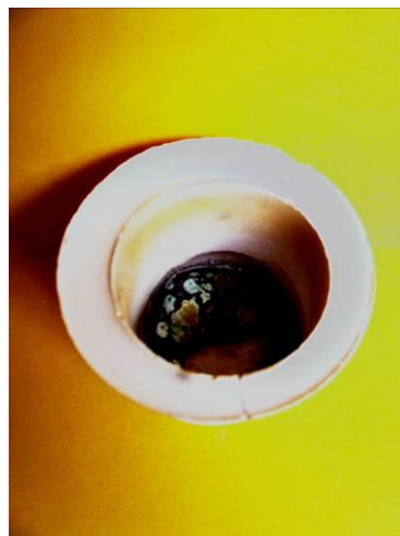
Figura 91. Crisol con el metal fundido en su interior
