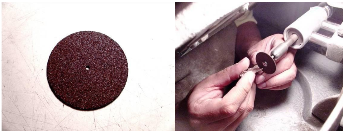
Figura 115 y 116. Disco abrasivo delgado y de diámetro grande
