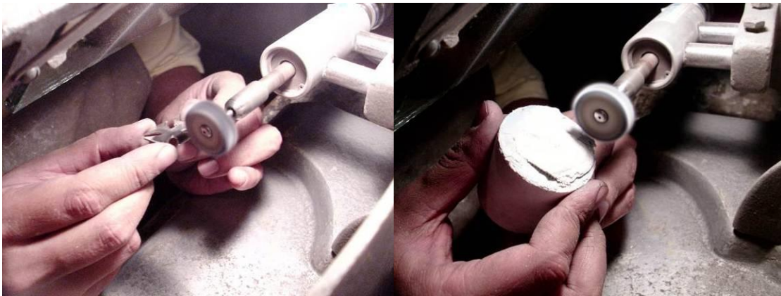
Figura 127 y 128. Disco de fieltro y pasta para realizar el pulimento
