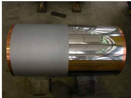
Figura 50. Pieza acabada con pulimento
