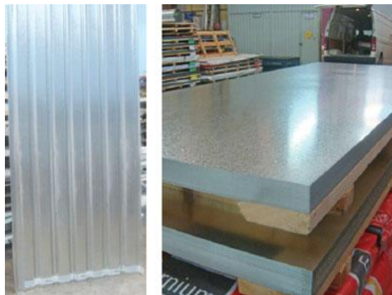
Figura 64. Lámina tratada mediante un proceso de galvanizado continuo por inmersión caliente
