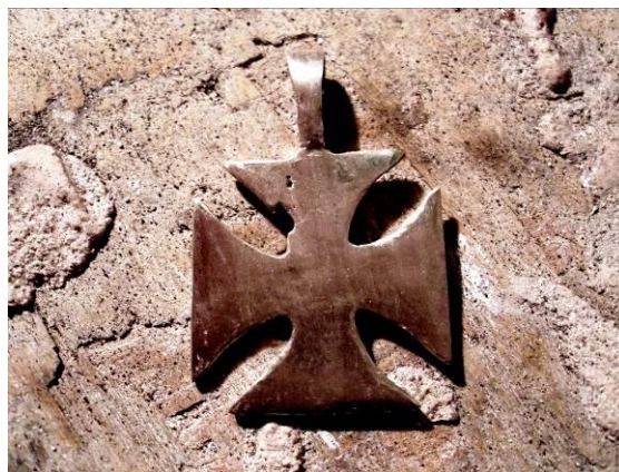
Figura 126. Pieza después del pulido con el disco y el cilindro de caucho
