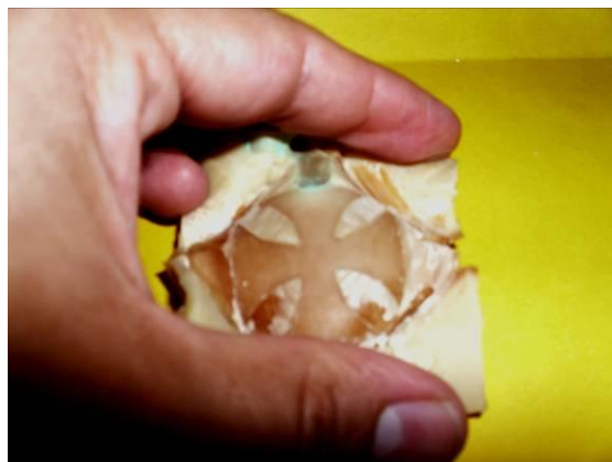
Figura 77. Impresión negativa del volumen de la maqueta base, en donde se rellenara de cera para formar el modelo
