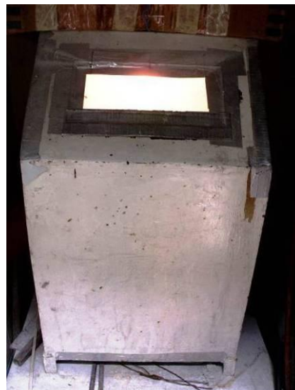
Figura 105. Cabina o cámara para la realización del arenado ( sandblasting )
