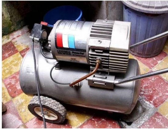
Figura 106. Compresor de aire utilizado para la limpieza por arenado
