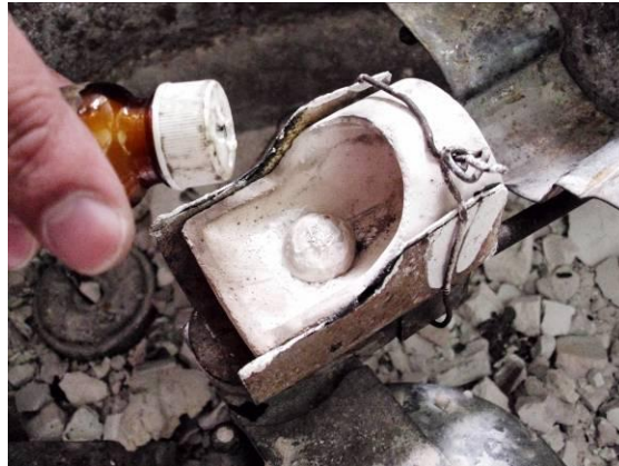
Figura 95. Crisol con la plata para fundir en su interior, agregándole bórax, antes de colocar el cilindro en la centrífuga
