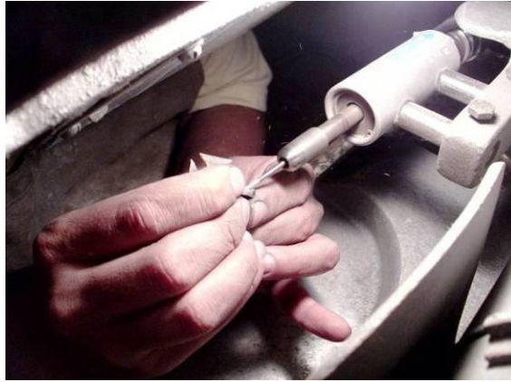
Figura 129. Perforación del asa con la fresa 703 de carburo de tungsteno
