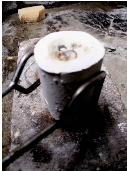
Figura 99. Cilindro retirado de la centrifuga después del colado, aún caliente
