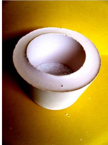
Figura 90. Crisol con bórax para la primera fundición
