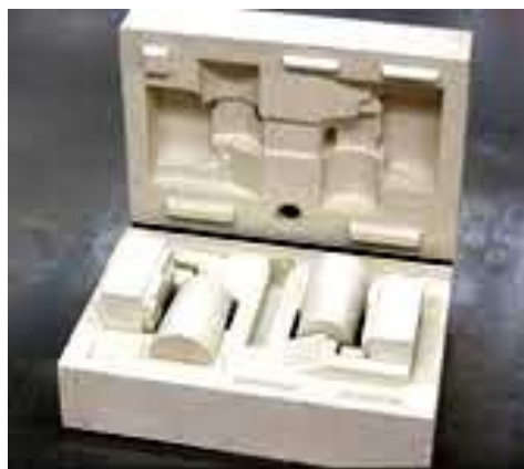
Figura 34. Partición del molde de yeso
