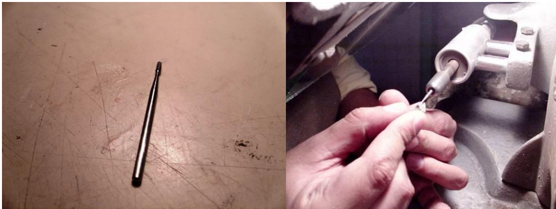
Figura 112 y 113. Fresa 703 de carburo de tungsteno
