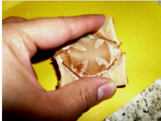
Figura 76. Interior del molde maestro, mostrando la impresión negativa de la maqueta base
