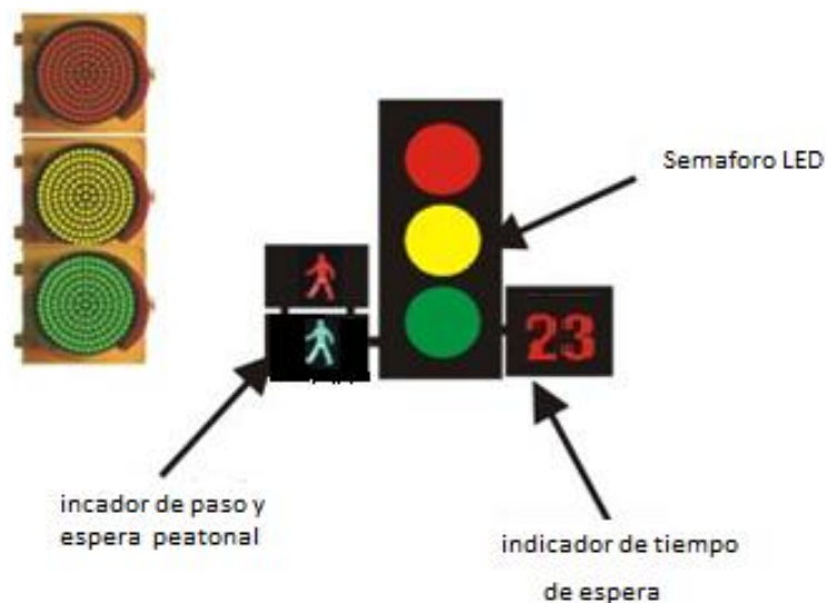
Figura 14. Semáforos instalados actualmente en la ciudad capital
