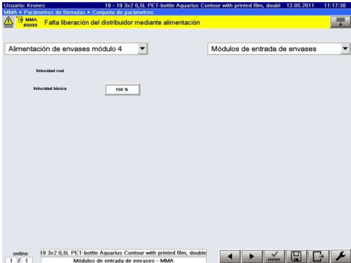
Figura 110. Pantalla de ajuste de velocidades, módulo 4 (recepción de envases)
