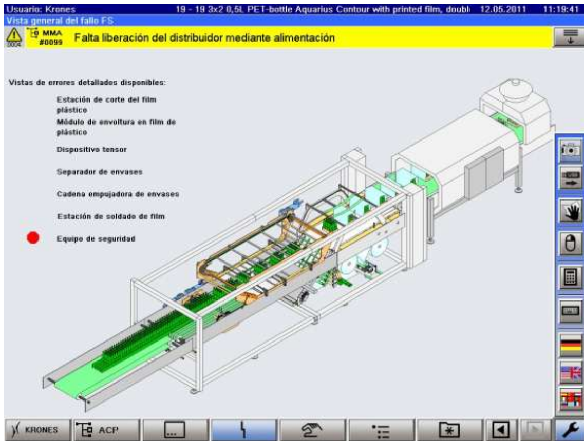
Figura 92. Pantalla de fallas
