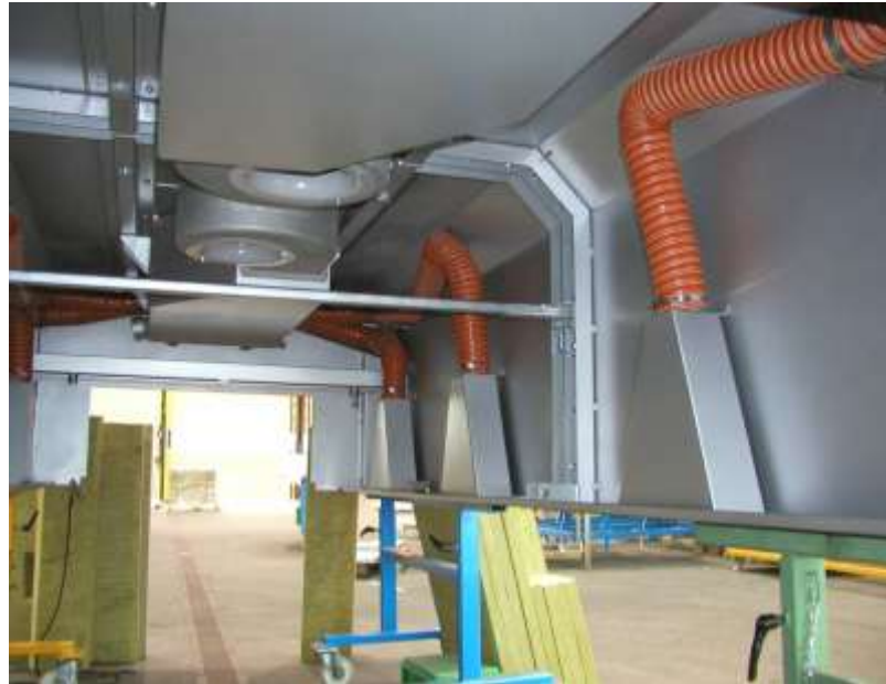
Figura 43. Salida trapezoidal de aire y tuberías de plástico de alta resistencia a la temperatura dentro del horno de contracción
