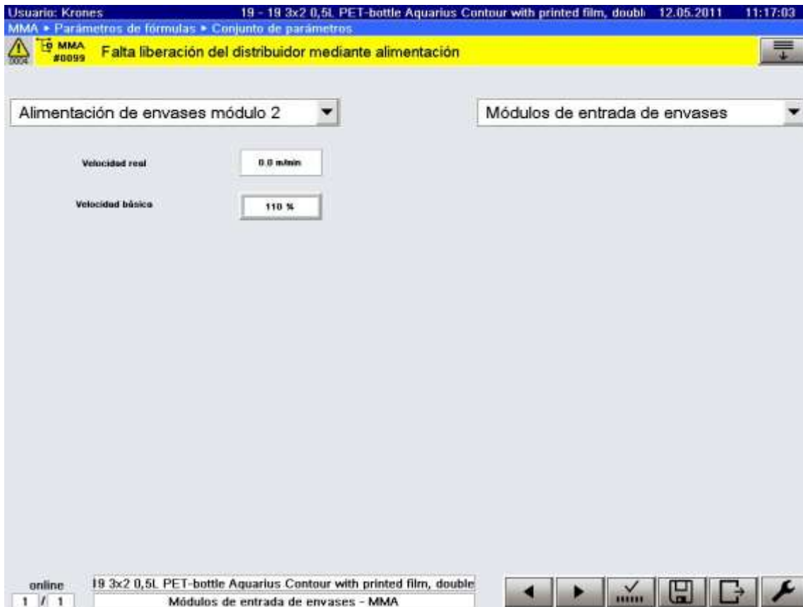
Figura 108. Pantalla de ajuste de velocidades, módulo 2 (separación y alineación de envases)
