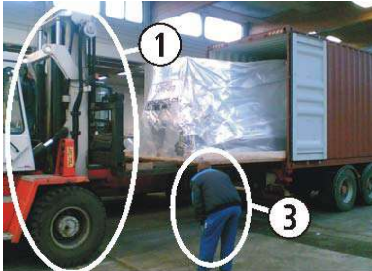
Figura 53. Extracción de la máquina del contenedor
