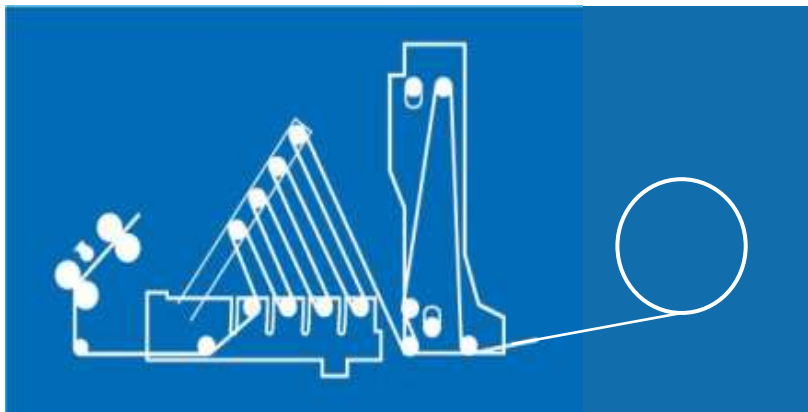
Figura 36. Diagrama de enhebrado de plástico del sistema de transporte de plástico
