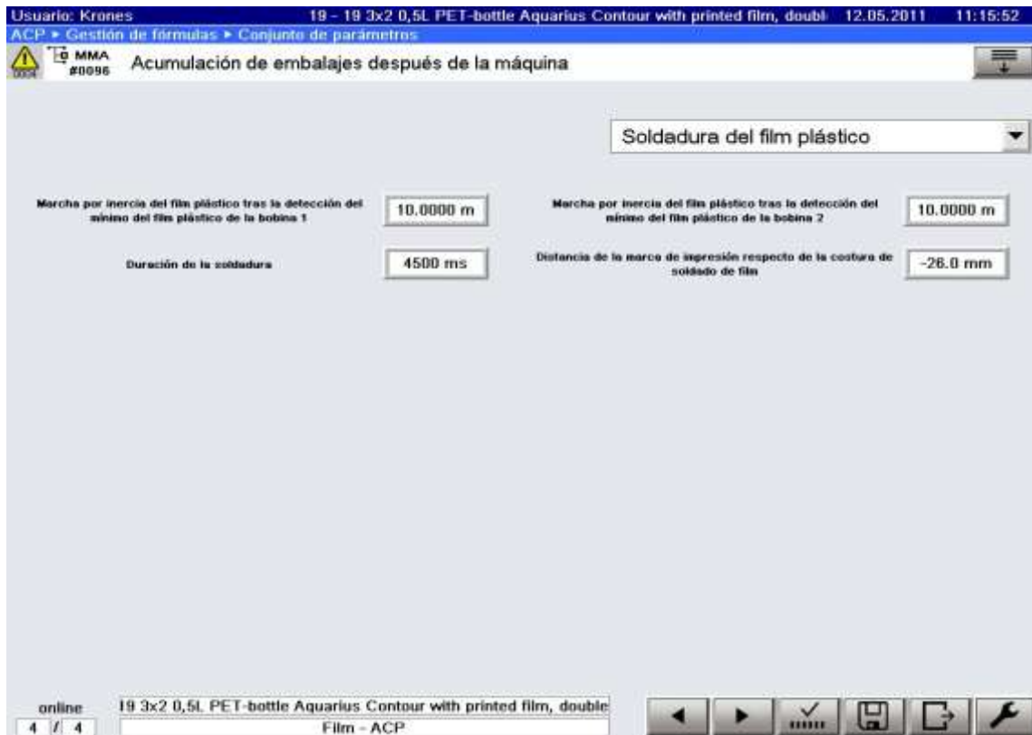
Figura 102. Pantalla de ajuste de la soldadura de hoja de plástico, conjunto de parámetros
