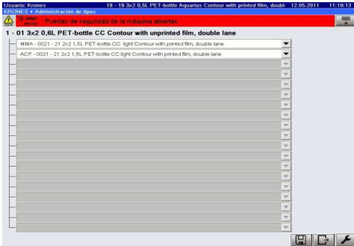
Figura 112. Pantalla de administración de tipos para los módulos de trabajo
