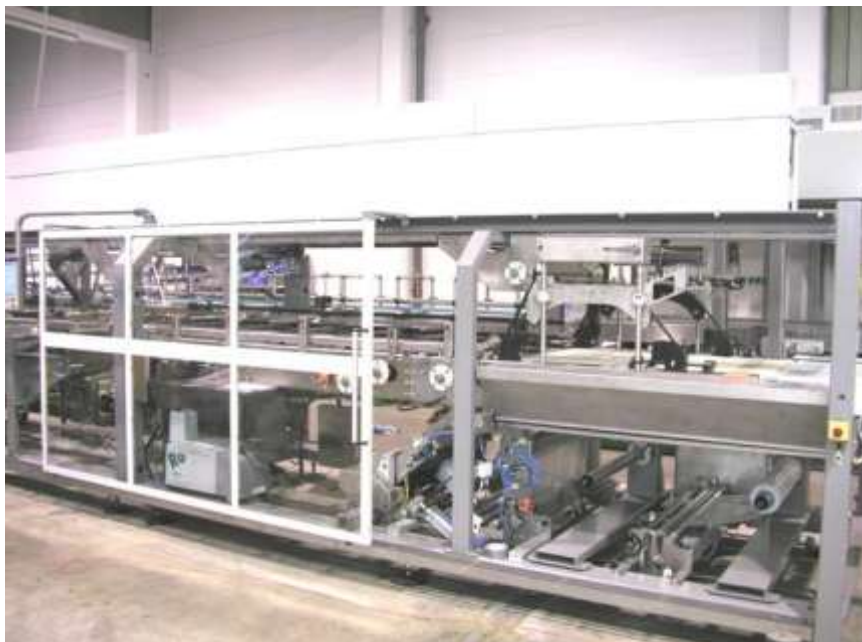
Figura 38. Puertas acceso a la máquina
