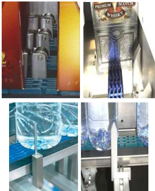
Figura 20. Distintos tipos de dedos separadores para distinto tipo de envase
