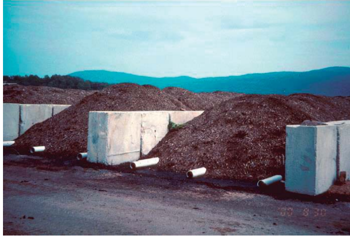
Figura 5. Pilas estáticas con aireación pasiva
