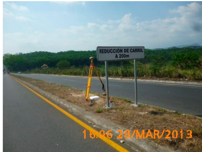
Figura 33. Posicionamiento GPS en el punto red OC01
