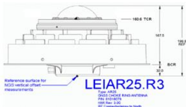
Figura 34. Esquema de la antena de la estación CORS
