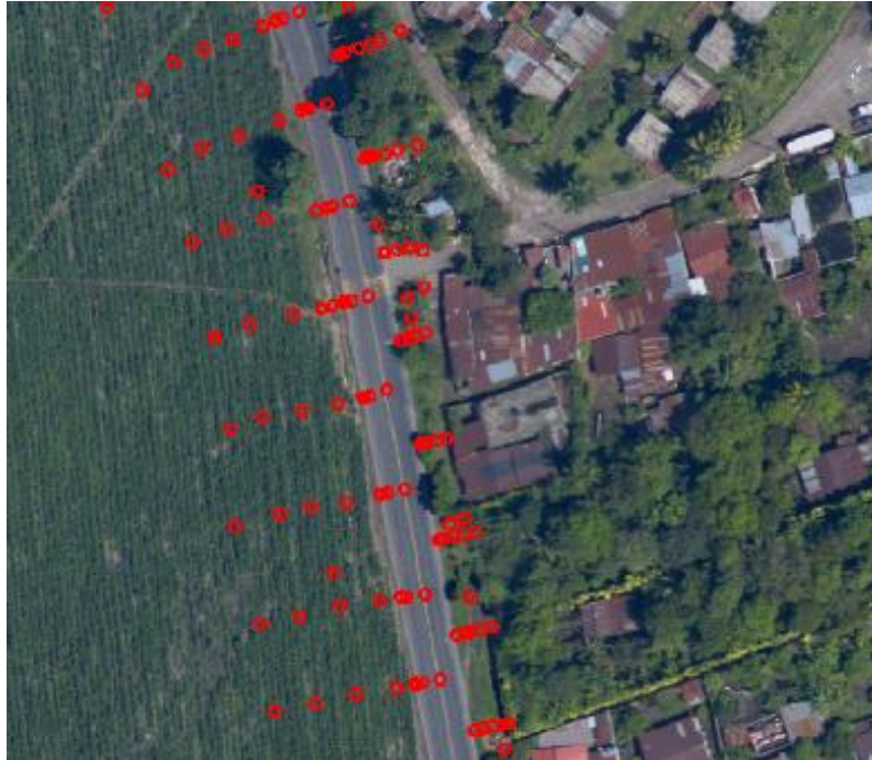
Figura 57. Secciones transversales con topografía convencional
