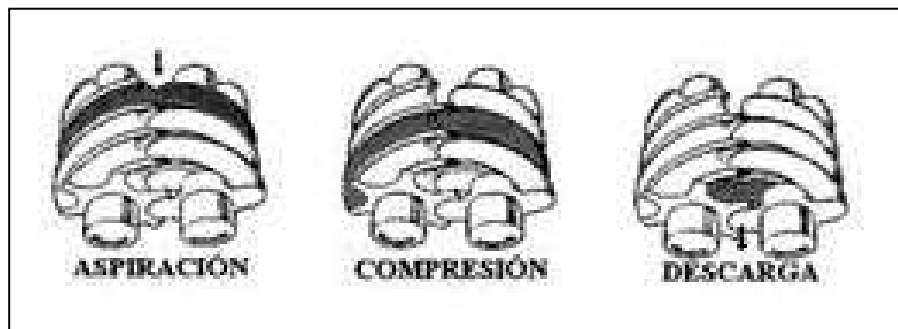
Figura 21. Fases de trabajo del compresor de tornillo
