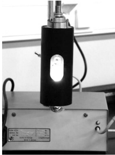
Figura 33. Fuente de sodio
