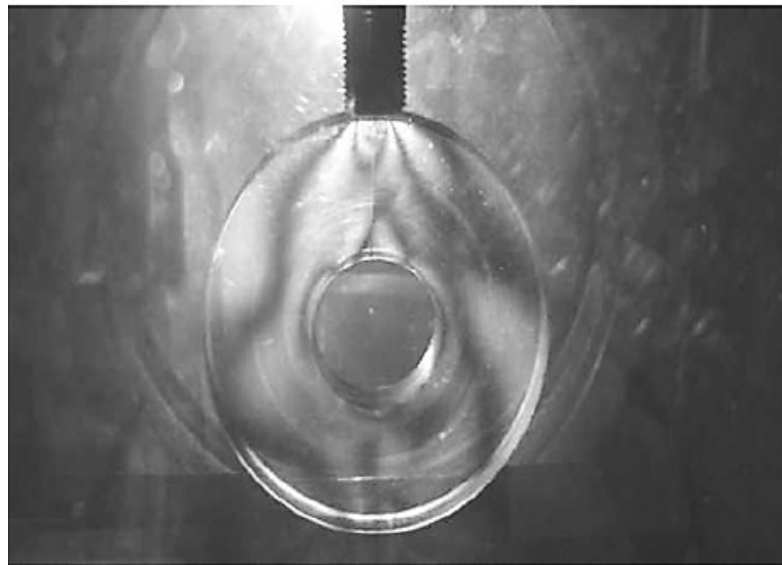
Figura 46. Ensayo a compresión con una carga de 230 psi
