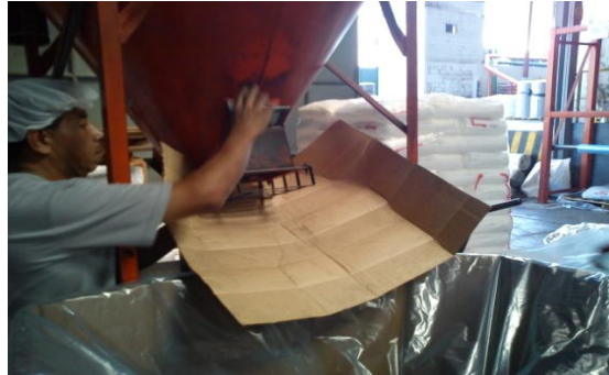
Figura 5. Técnica de vaciado de mezcladora en situación actual (I)
