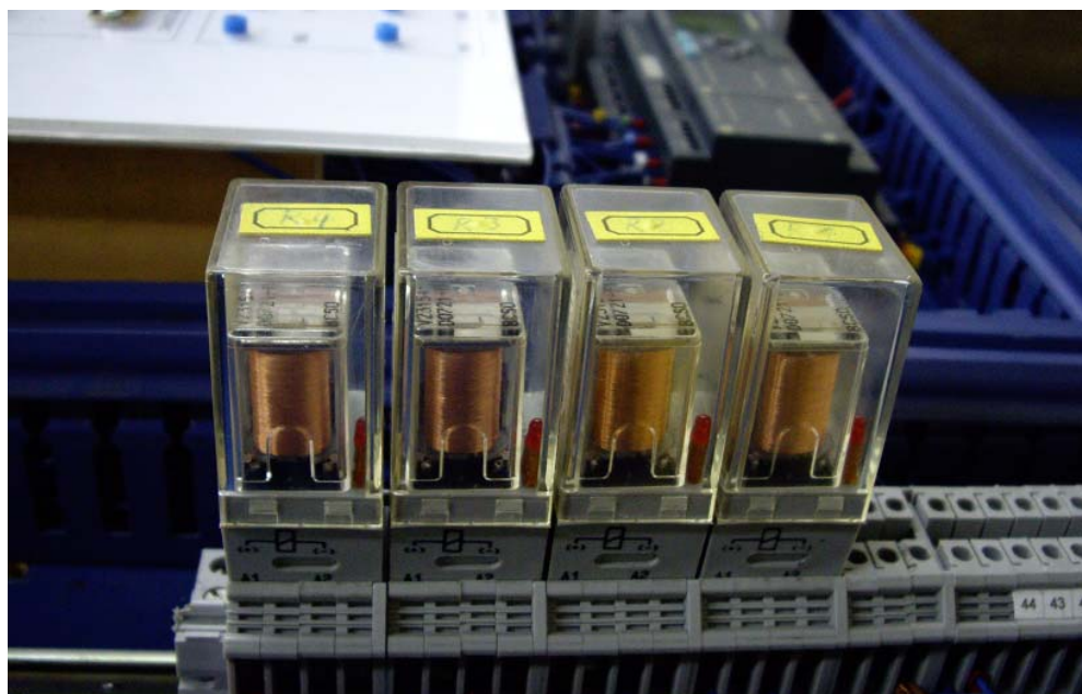
Figura 86. Relés con dos contactos secos y bobina 24 VDC
