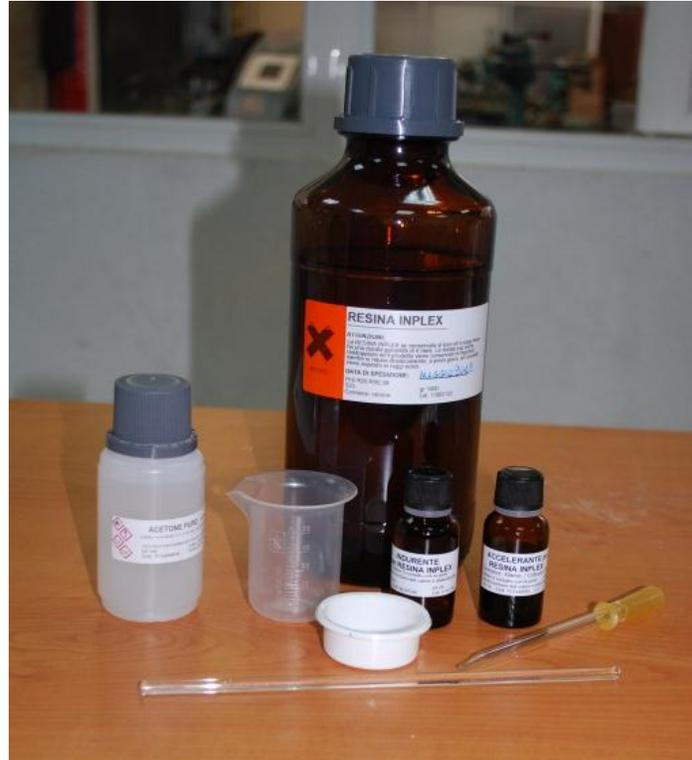
**Figura 4.20** Resina en frío e implementos de empastillado
