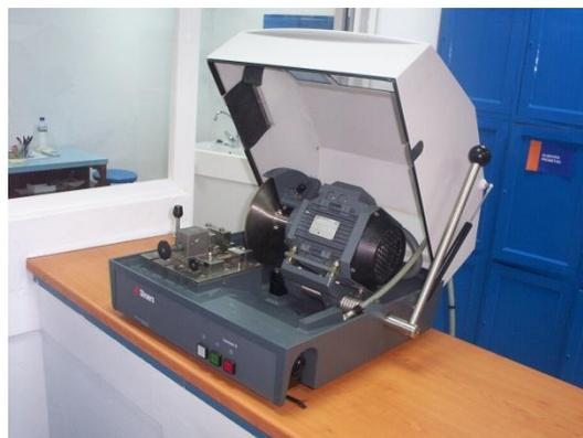
**Figura 3.14** Máquina de corte con sierra de diamante Labotom 3
