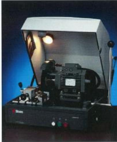
**Figura 3.17** Cortadora Metalográfica
