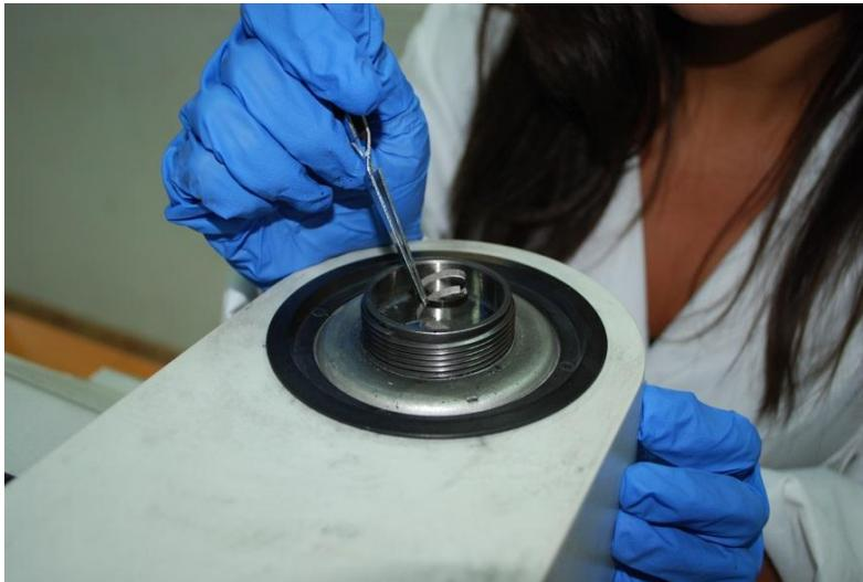
**Figura 4.22** Colocación de la viruta en el émbolo.
