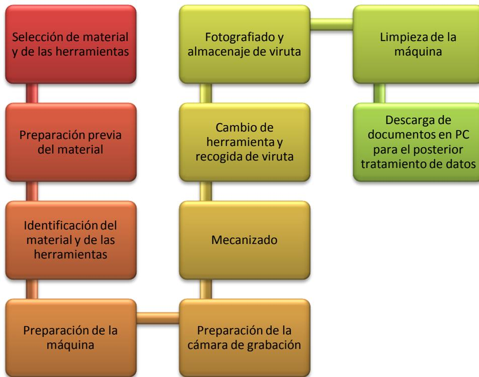
**Figura 4.2** Secuencia de Operaciones Básicas para la caracterización de la viruta.
