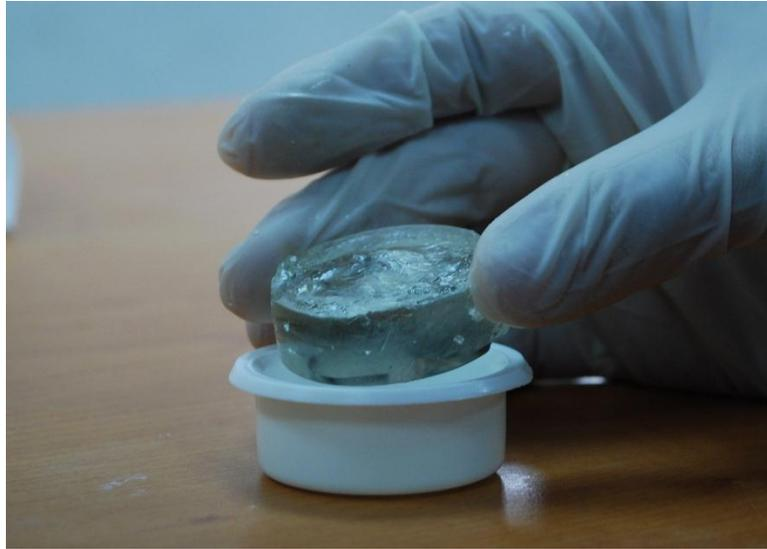
**Figura 4.31** Extracción de la muestra encapsulada.
