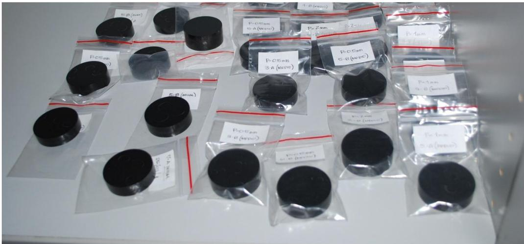
**Figura 5.5** Muestras empastilladas con resina en caliente.
