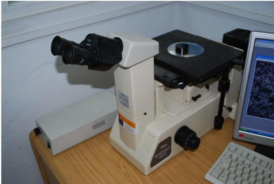
**Figura 4.43** Microscopio Metalográfico
