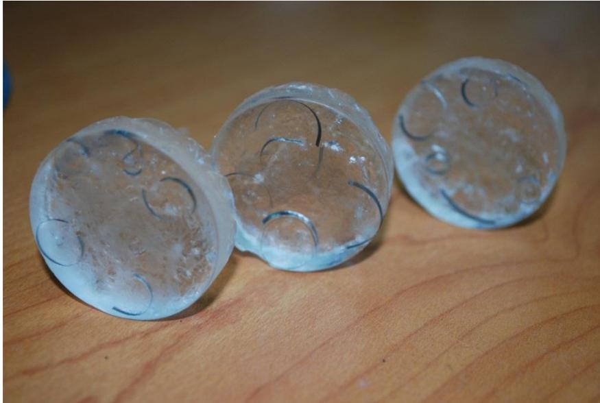
**Figura 5.6** Muestras empastilladas con resina en frío
