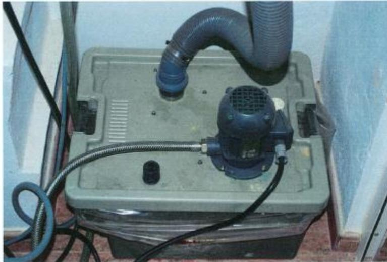
**Figura 3.19** Bidón de refrigerante y bomba con conductos de recirculación
