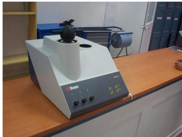
**Figura 3.15** Máquina de embutición Labopress 3
