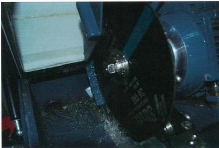
**Figura 3.20** Refrigerante incidiendo sobre el disco.
