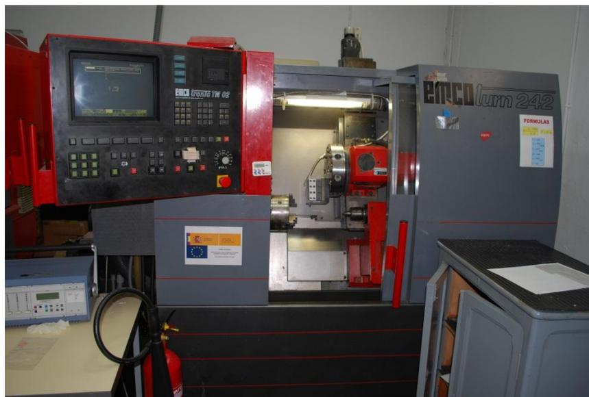
**Figura 4.7** Centro de mecanizado EMCOTurn 242 con control numérico EMCOTronic TM02
