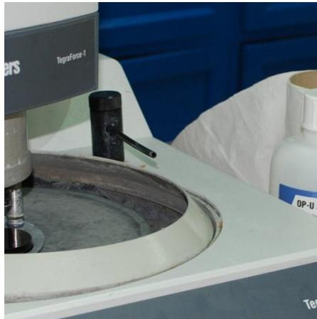
**Figura 4.37** Colocación de la caña del grifo de lubricante
