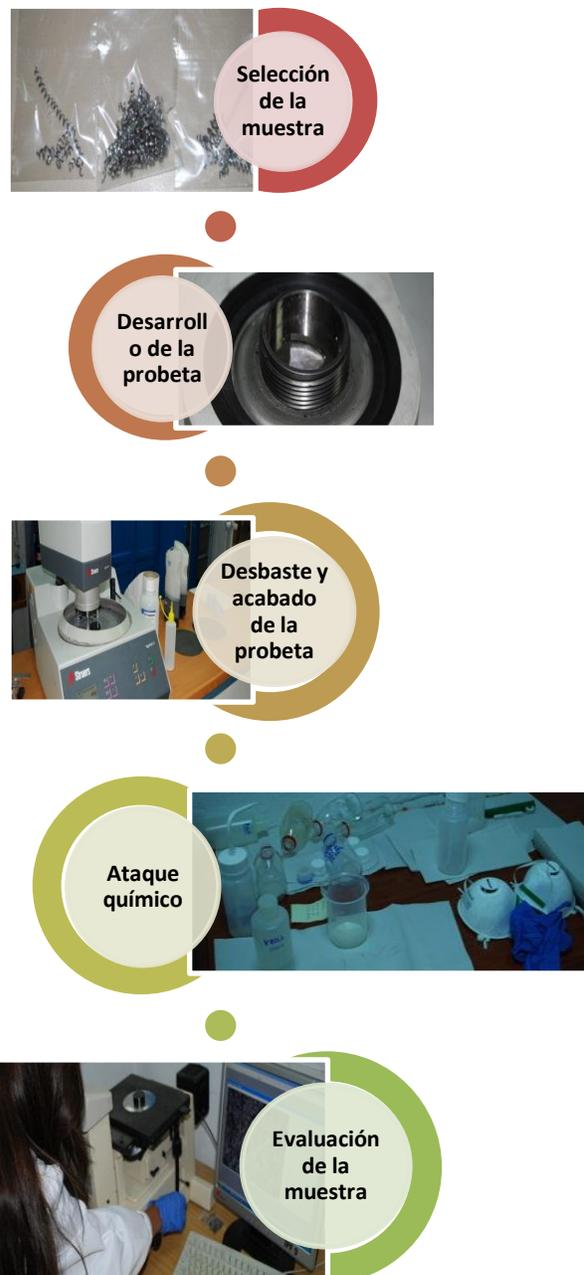
**Figura 4.13** Diagrama de Flujo Manipulación de muestra
