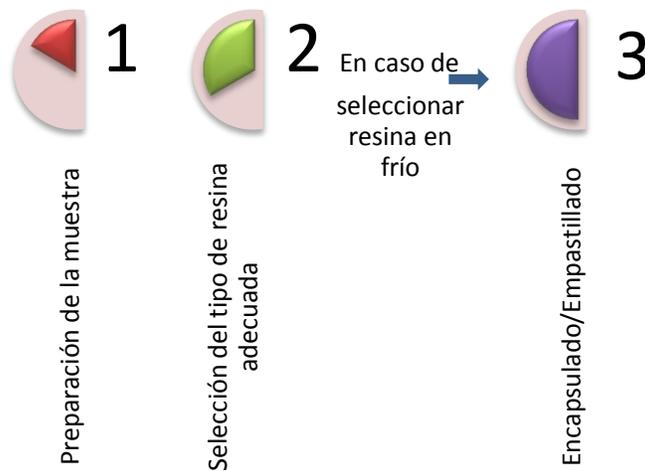
**Figura 4.16** Pasos para el proceso de encapsulado. (Resina en Frío)
