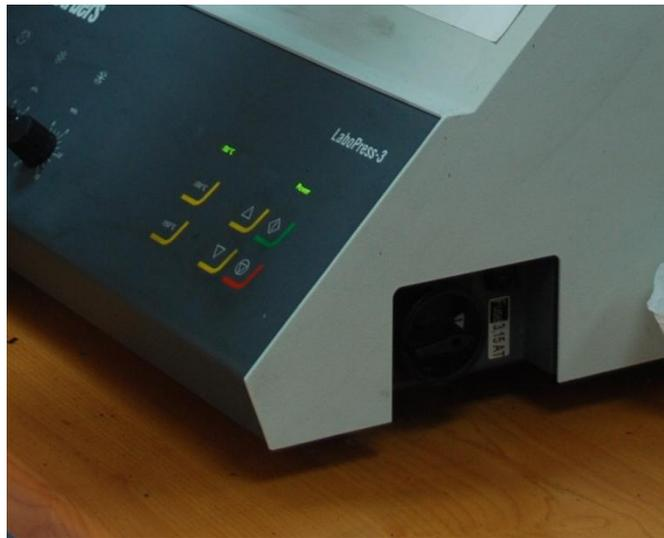
**Figura 4.21** Botón encendido de la máquina
