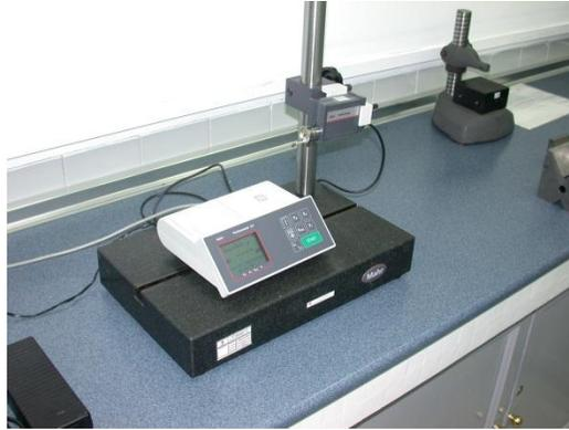
**Figura 3.9** Rugosímetro de palpador tipo “Perthometer M1”
