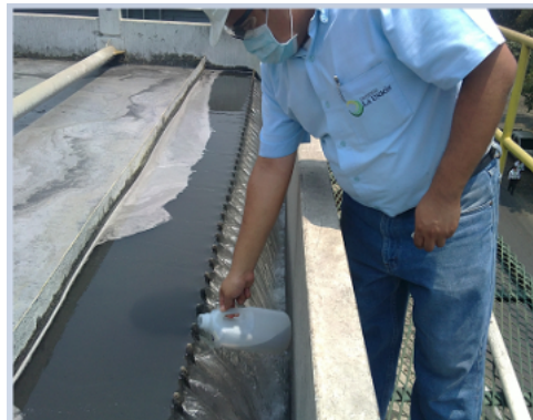
Figura 26. Toma de muestra en vertedero de decantador
