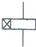
Contactor electromecánico con retardo de accionamiento.
