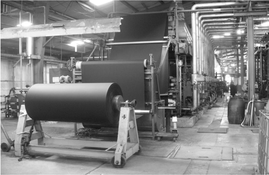
Figura 16. Vista lateral de máquina lavadora textil.
