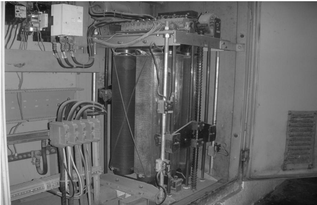
Figura 11. Vista del sistema motriz del motor 1m21 que mueve los carbones.
