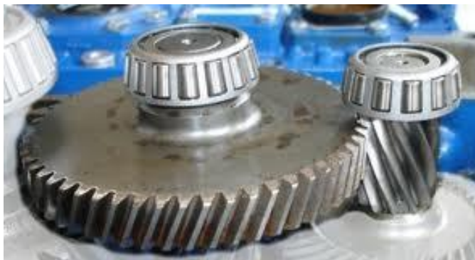
Figura 6. Engranajes de ejes paralelos cilíndricos de dientes helicoidales
