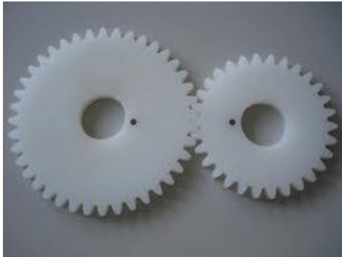
Figura 5. Engranajes de ejes paralelos cilíndricos de dientes rectos
