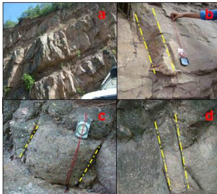
Figura 43. Patrón de fractura en las unidades litológicas (a-b capas rojas y c-d areniscas y conglomerados)
