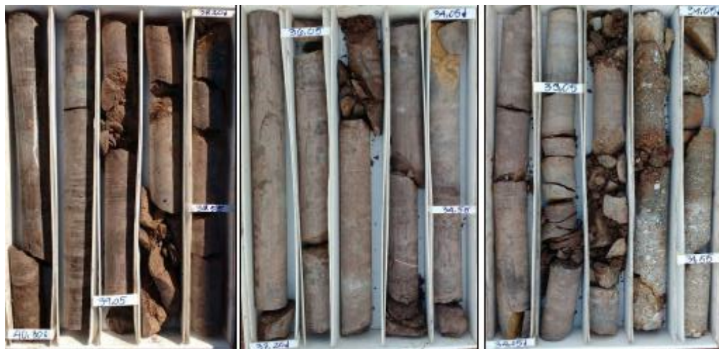
Figura 44. Testigos de suelo recuperados en los sondeos con perforación rotativa
