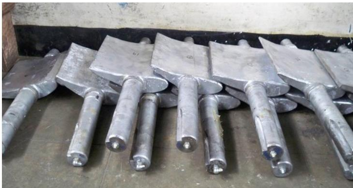
Figura 27. Paletas o alabes directrices reacondicionados
