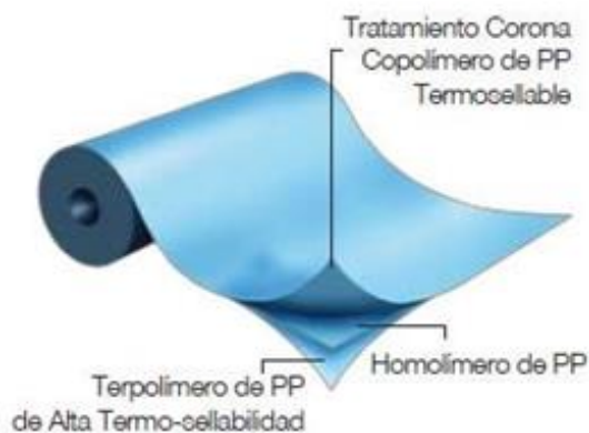
Figura 3. Estructura de polipropileno
