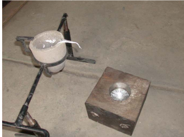
Figura 36. Fundición en molde de acero al medio carbono
