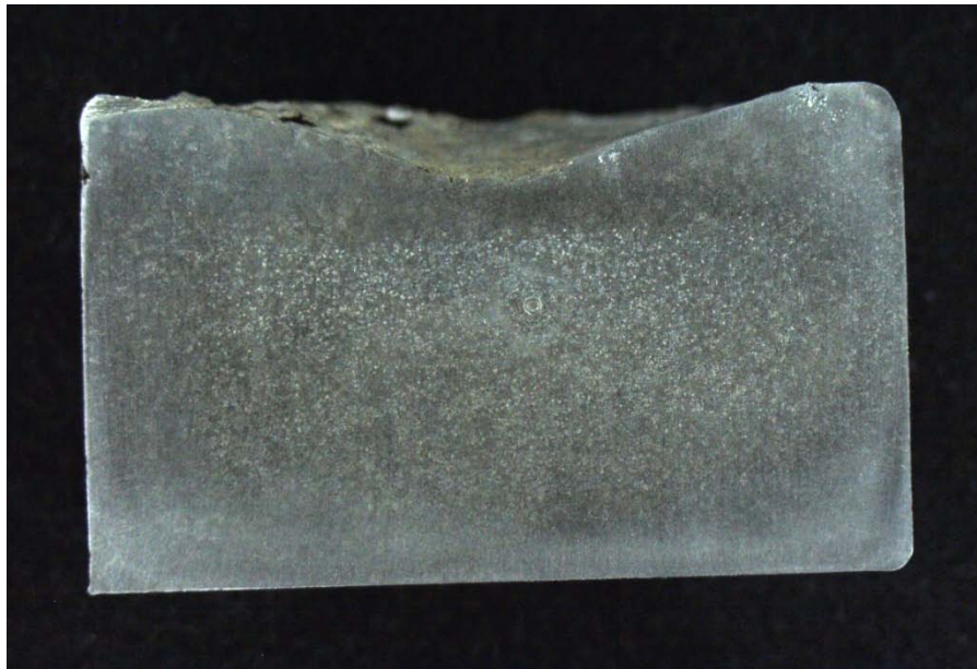
Figura 58. Lingote número tres. 1% cobre
