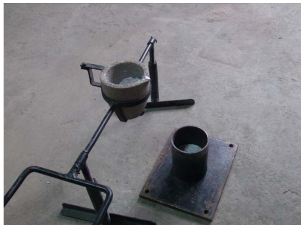
Figura 37. Fundición en molde hecho de tubo de acero de bajo carbono
