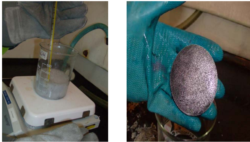
Figura 43. Ataque experimental con soda caustica
