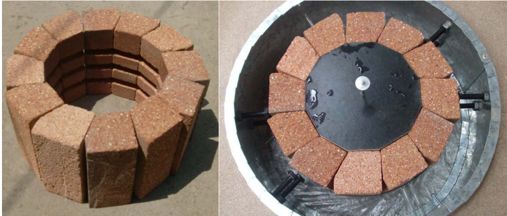
Figura 15. Constitución del cuerpo del horno
