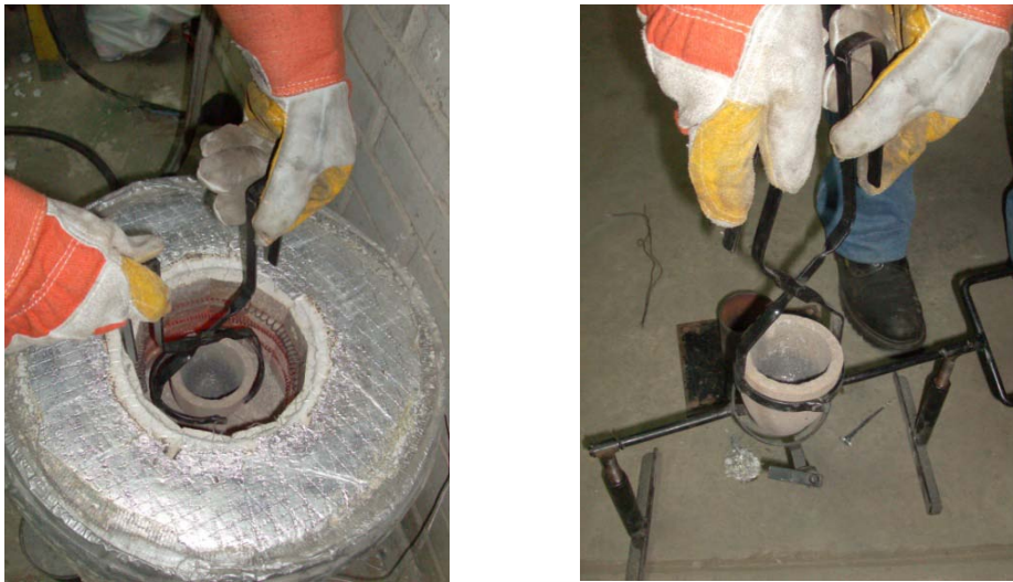
Figura 39. Proceso de extracción del crisol
