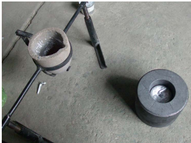
Figura 35. Fundición en molde de grafito
