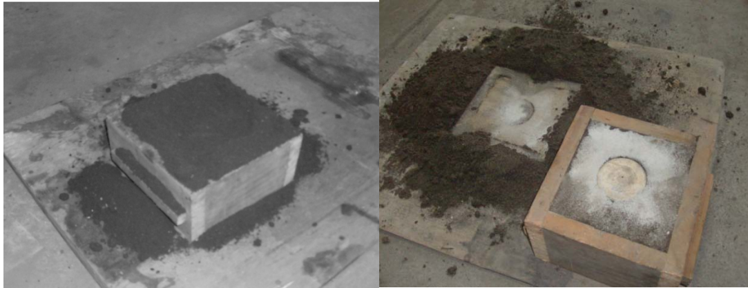
Figura 29. Lingotera tipo caja de arena
