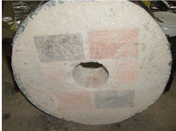
Figura 13. Construcción de la tapa del horno
