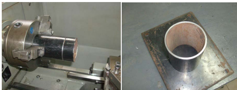
Figura 28. Mecanizado de lingotera de tubo de acero de bajo carbono
