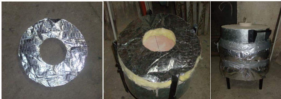
Figura 19. Aislamiento en las juntas de las partes
