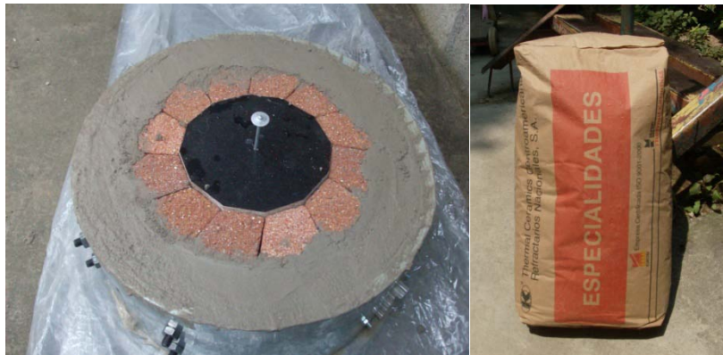
Figura 16. Cuerpo del horno y cemento refractario
