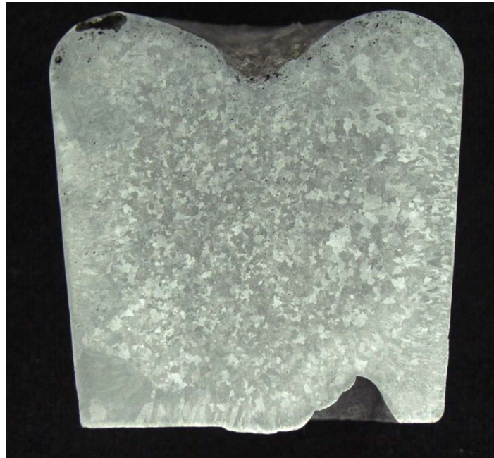
Figura 57. Lingote número dos. 1% cobre
