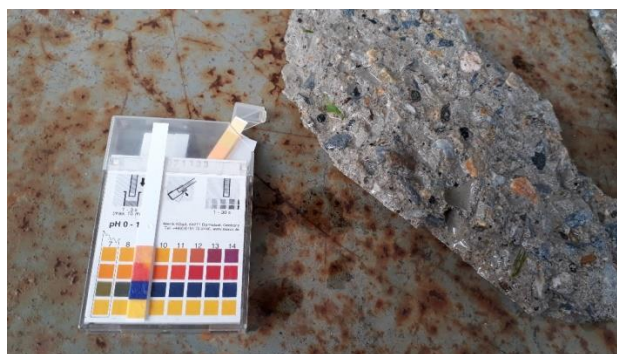
Figura 20. Ensayo de carbonatación a espécimen de concreto reforzado con azúcar como aditivo retardante del hormigón
