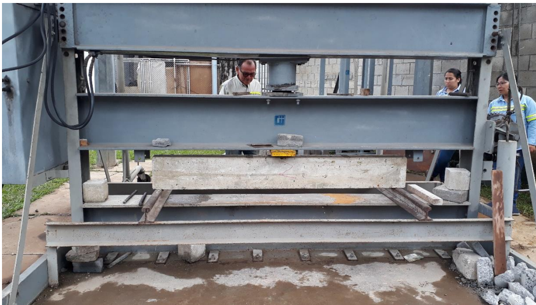
Figura 24. Colocación del elemento viga para ensayo a flexión
