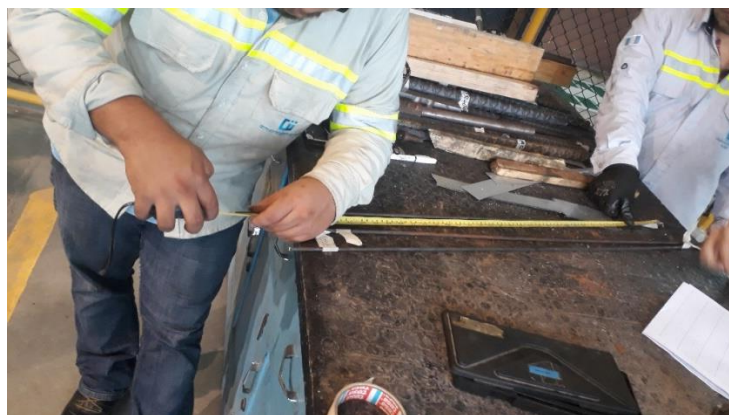
Figura 17. Toma de datos de longitud a especímenes de prueba de resistencia del acero estructural
