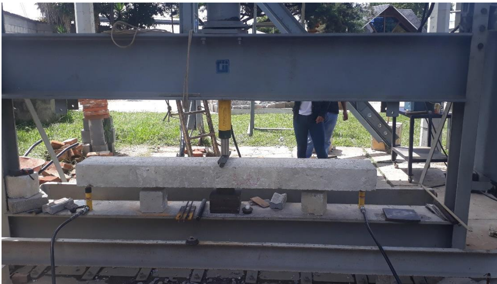
Figura 42. Colocación de elemento viga para ensayo a torsión
