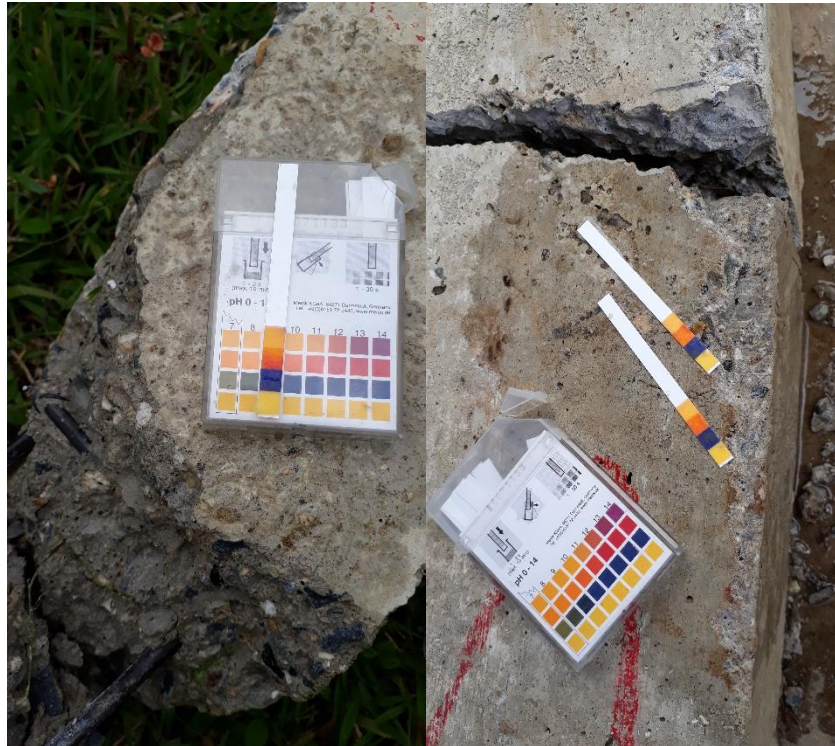
Figura 21. Ensayo de carbonatación a espécimen de concreto reforzado sin ningún tipo de aditivo
