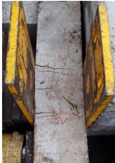
Figura 41. Ensayo de corte a elemento viga con azúcar como aditivo retardante del hormigón
