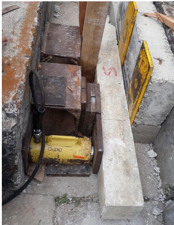
Figura 33. Colocación de elemento columna para ensayo a corte
