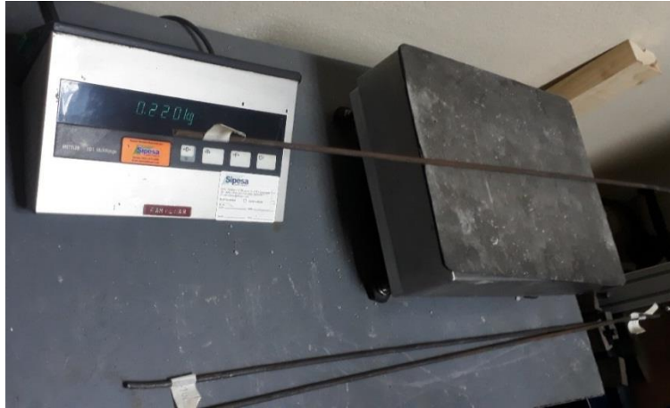
Figura 18. Toma de datos de peso a especímenes de prueba de resistencia del acero estructural
