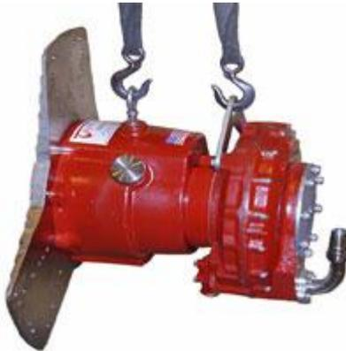
Utilice el dinamómetro portátil TD-3100 del Taylor Dynamometer para medir rápidamente la energía del motor. Puede realizar las pruebas en interior o exterior. Simplemente monte el dinamómetro directamente en el motor. No necesita un soporte de motor especial o célula de prueba. Incluso puede probar el motor mientras está sentado en el cajón de envío. Todo lo que necesita es un suministro de agua para el dinamómetro. La mecánica de nivel de entrada
