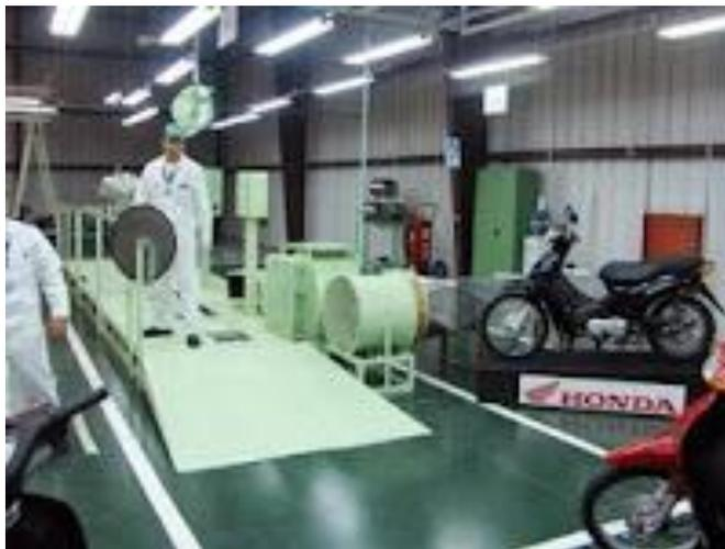
Para conocer el estado de salud del motor a combustión interna se efectúa una prueba de fuerza: la fuerza del motor (Cuantos caballos, cuantos hp, etc)
