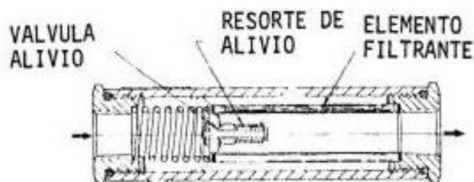
Figura 23. Cilindro con filtro en línea
