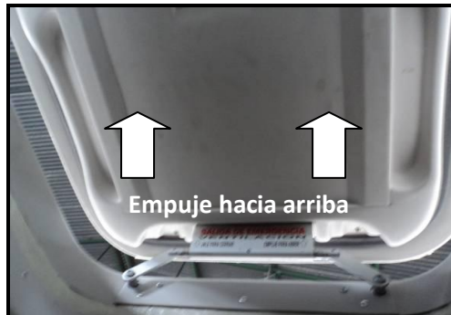
Figura 42. Salida de emergencia, abierta
