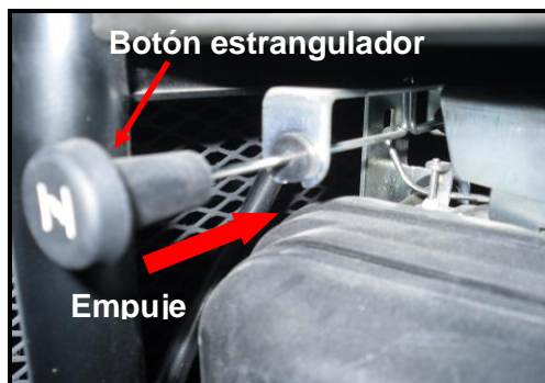
Figura 12. Estrangulador de combustible
