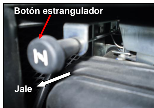
Figura 8. Botón estrangulador de combustible
