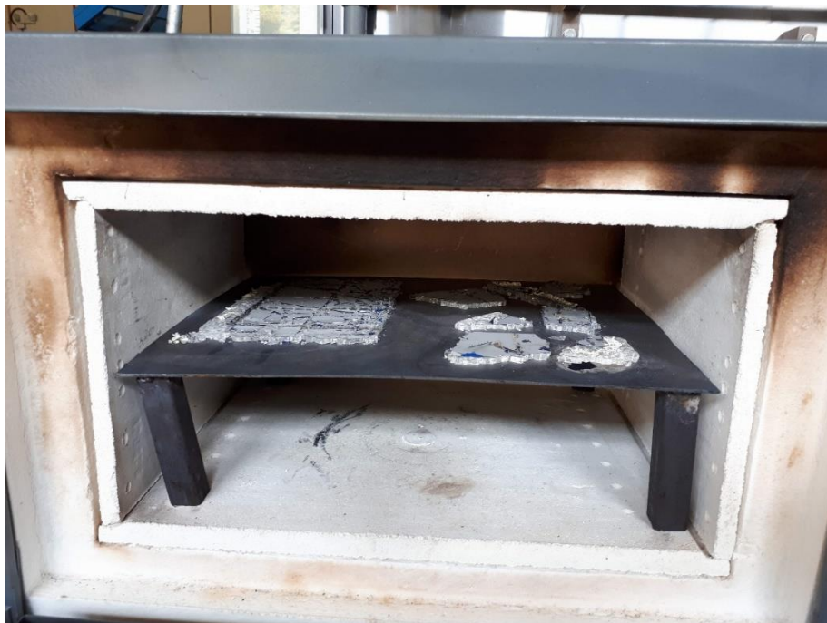
Figura 14. Muestras luego de tratamiento térmico en mufla
